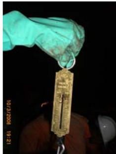
Foto 5.4. Balanza utilizada en el Pesaje de Residuos Sólidos
