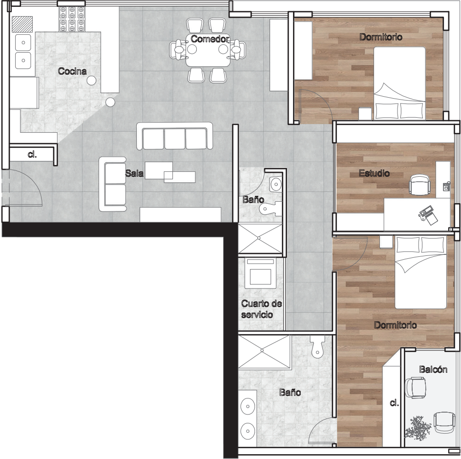
PLANTA VIVIENDA TIPO B1 ESC 1:100
