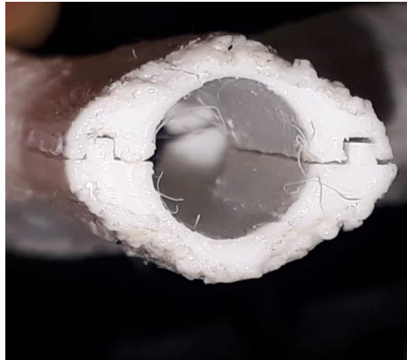
Figura 57: Ensamble de partes manufacturadas por deposición fundida, con un espesor de capa igual a 0.05 y un material ABS, se evidencia el ensamble de sus partes.
