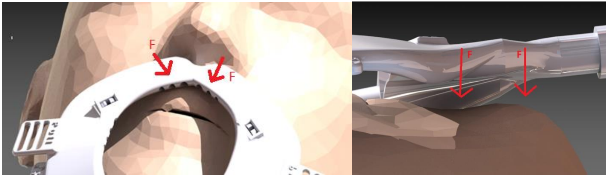
Figura 32: Enfoque ergonómico del producto sobre la aplicación de las fuerzas en tejidos duros, como lo recomienda (Romero & Barrionuevo, 2017), aplicando en el maxilar superior y maxilar inferior.
