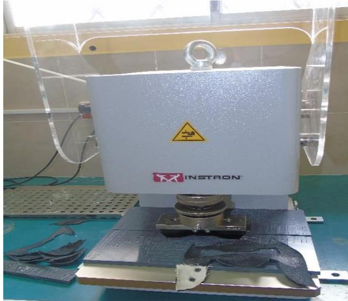
**Figura 5.** Troqueladora de probetas, marca INSTRON (EPN, 2015)
