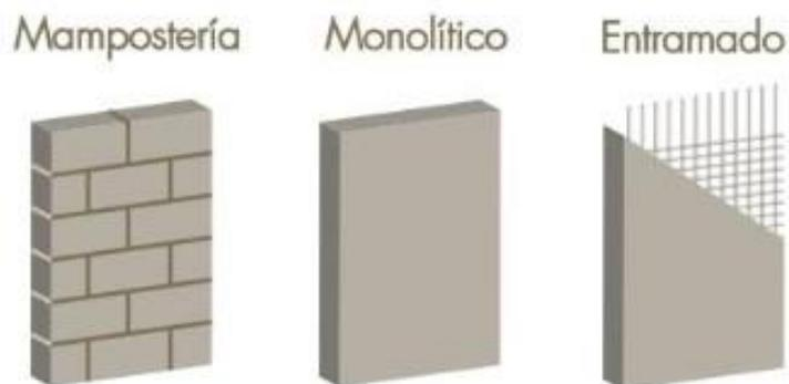
Figura 1. Principales tipos de muro.
