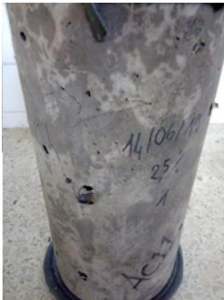
Figura 22. Rotura a compresión del espécimen de la mezcla de suelo-cemento plástico con  $f_c/c=0.025$  de refuerzo de fibras de coco.
