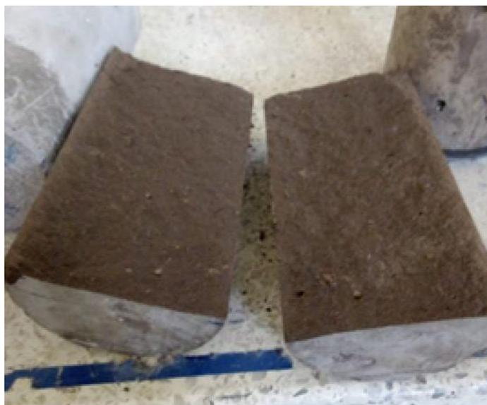
Figura 27. Rotura del espécimen de suelo-cemento plástico.
