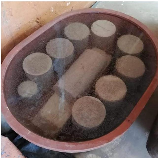
Figura 14. Proceso de curado de los especímenes endurecidos.
