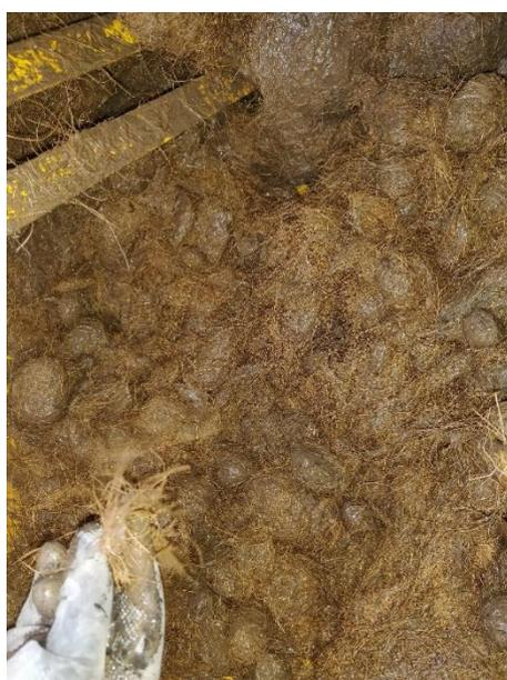
Figura 19. Apreciación del efecto bola con altas concentraciones de fibras de coco.
