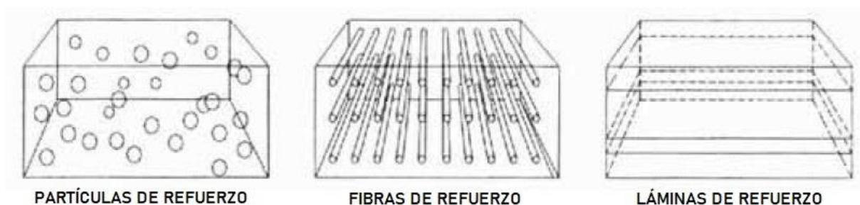
Figura 4. Tipos de refuerzo en los materiales compuestos
