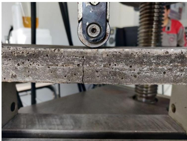
Figura 39. Rotura a flexión del suelo-cemento plástico reforzado con piedra pómez.
