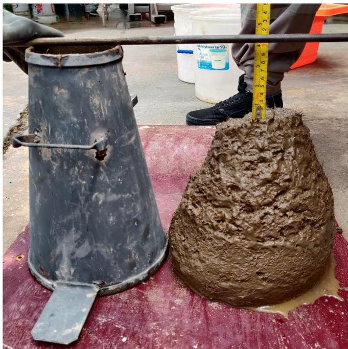
Figura22. Ensayo de revenimiento.
