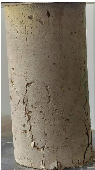
Figura 23. Rotura a compresión del espécimen de suelo-cemento plástico.
