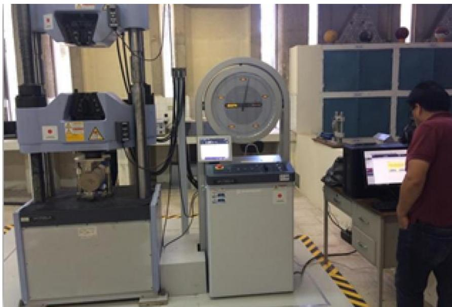
Figura 15. Ensayo de resistencia a tensión por compresión diametral.
