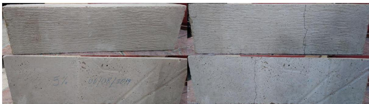
Figura 33. Evolución del estado del espécimen expuesto a las condiciones medioambientales.
