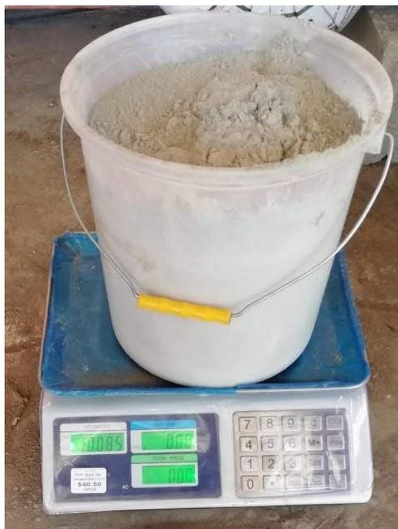
Figura 10. Dosificación por masa del cemento portland.
