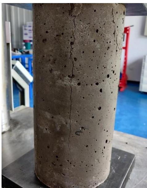
Figura 36. Rotura a compresión del suelo-cemento plástico reforzado con piedra pómez.
