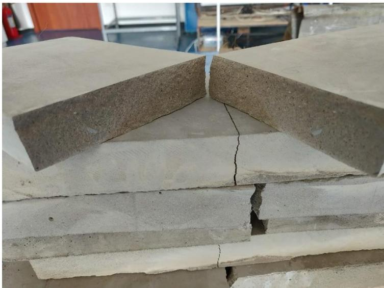
Figura 31. Rotura a flexión del espécimen de la mezcla de suelo-cemento plástico.
