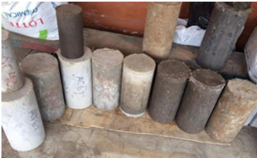
Figura 13. Especímenes cilíndricos de suelo-cemento plástico reforzado con fibras de coco y combinado con polvo de coco.
