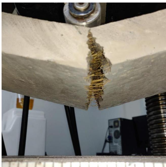
Figura 30. Rotura a flexión del espécimen de la mezcla reforzada con fibras de coco.
