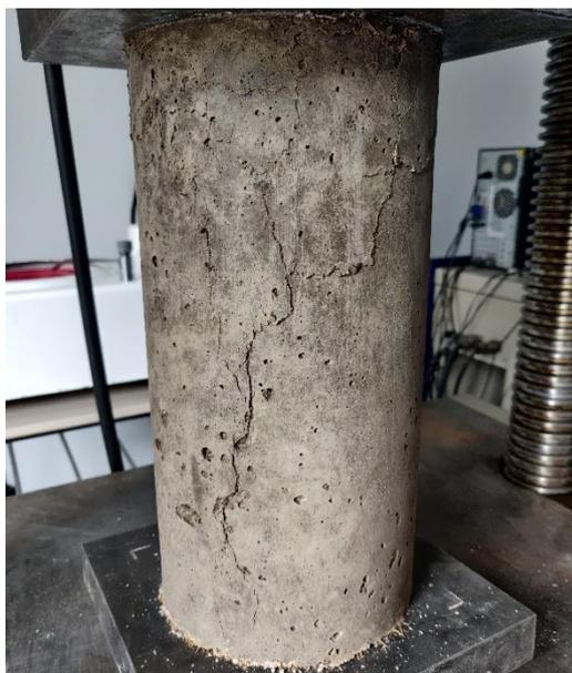
Figura 37. Rotura a compresión del suelo-cemento plástico reforzado con piedra pómez y fibras de coco.
