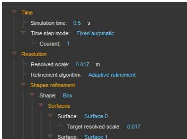
Figura 25. Mallado del Elemento
