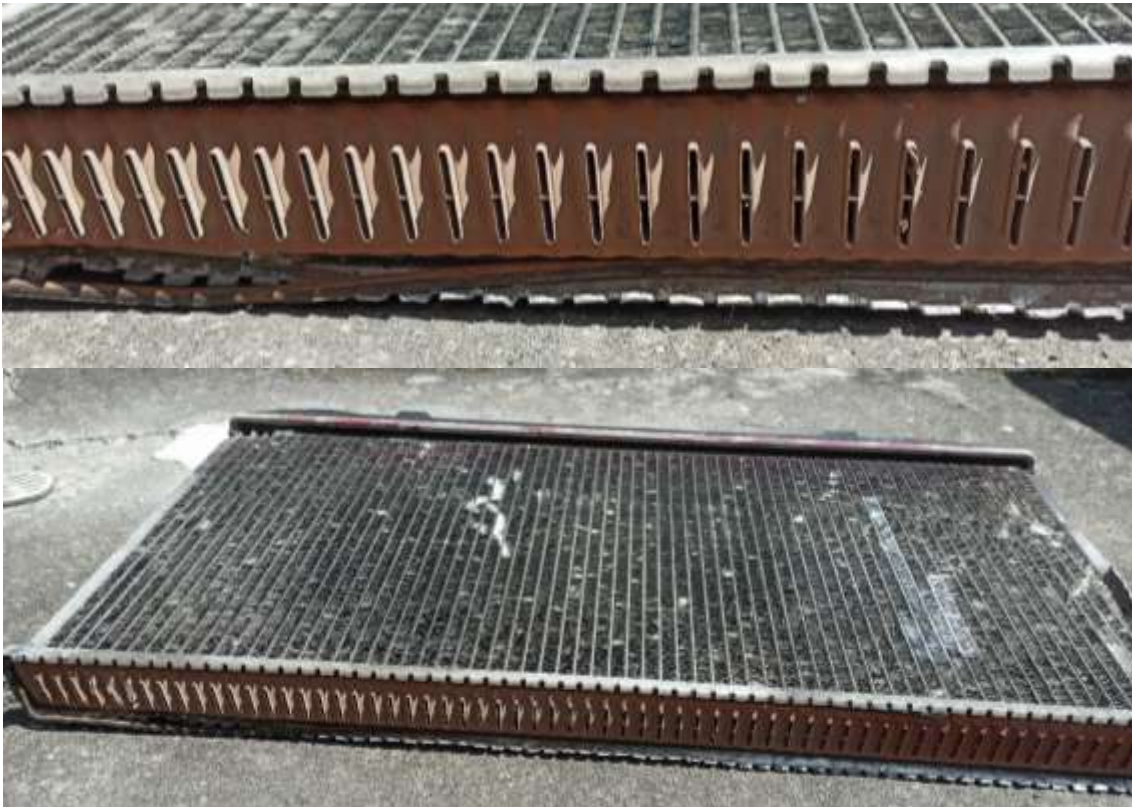
Figura 21. Radiador recortado la base para la toma de sus dimensiones
