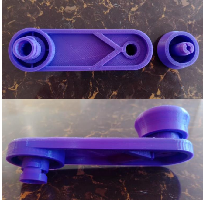
Figura 33 Manija optimizada impresa en 3D
