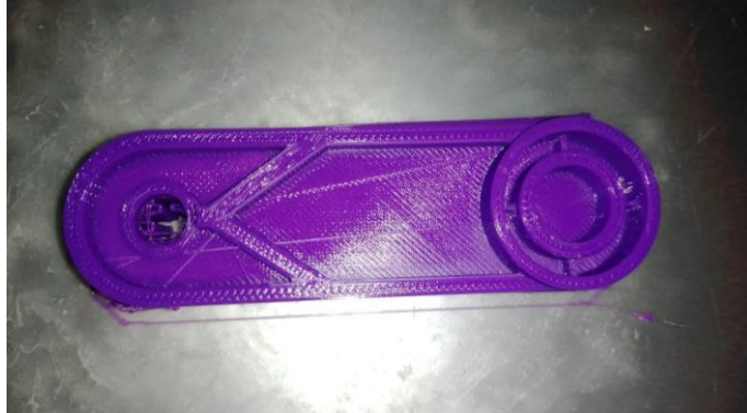
Figura 31 Vista superior de la parte media optimizada impresa en 3D
