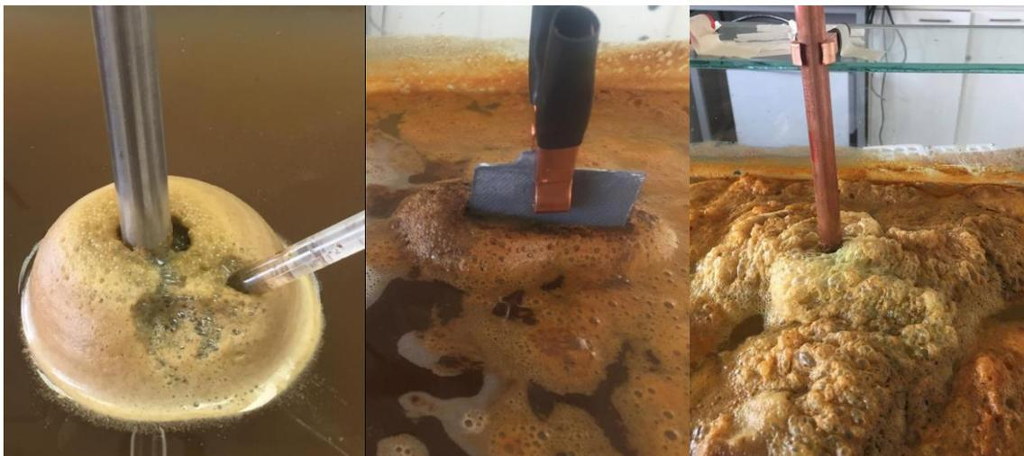
*Figura 18. Formación de gases en cátodos (Tomada por: Vásquez Ma. Augustha)*
