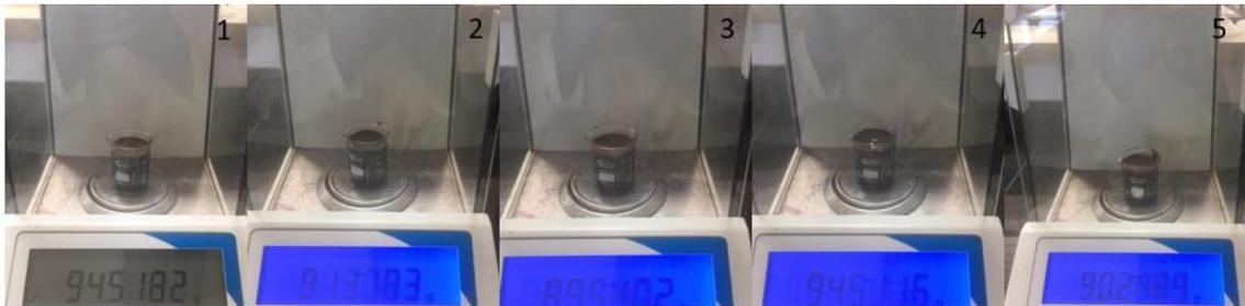
**Figura 14. Pesos de vasos de precipitación de 50 mL con muestra de lodo. (Tomada por: Vásquez Ma. Augustha)**
