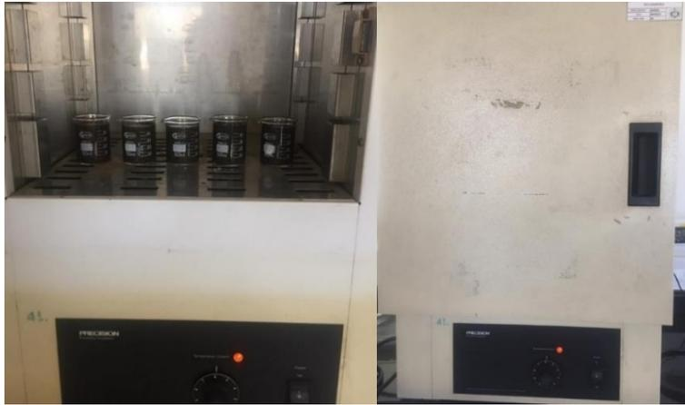
*Figura 15. Muestras de lodo a secar en una incubadora. (Tomada por: Vásquez Ma. Augustha).*
