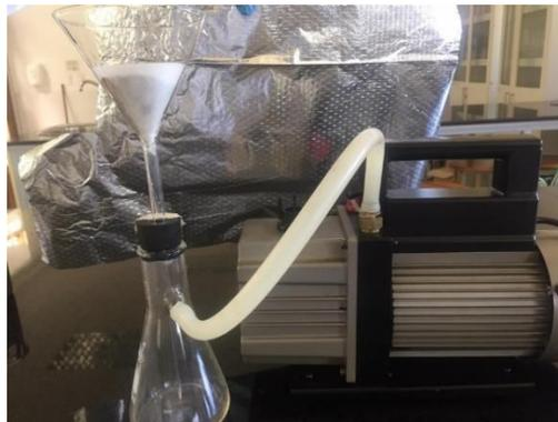
*Figura 16. Filtración de muestra (Tomada por: Vásquez Ma. Augustha)*
