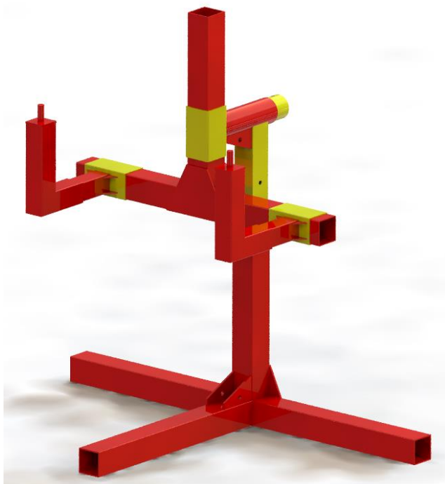
Figura 29 Ensamblaje estructural del equipo
