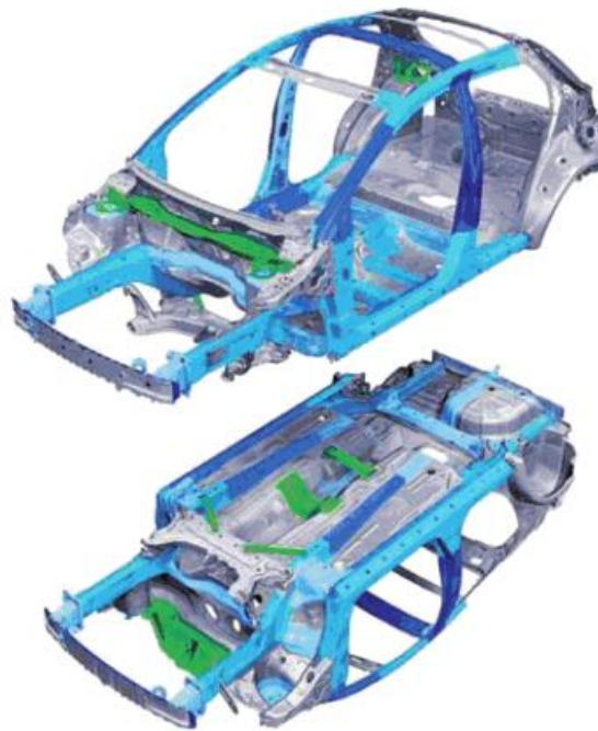
Figura 13 Vista superior e inferior de una carrocería autoportante (Gómez, Navarro, Águeda, Gracia, & García, 2009)
