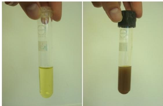
Fotografía A.3 Extracto obtenido por destilación por arrastre con vapor utilizando cáscara seca
