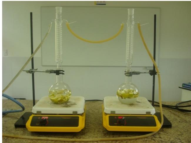
**Figura 15.** Extracción directa a reflujo con agua y alcohol potable en el laboratorio
