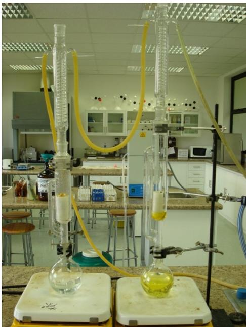
**Figura 17.** Esquema de la extracción continua en Soxhlet en el laboratorio
