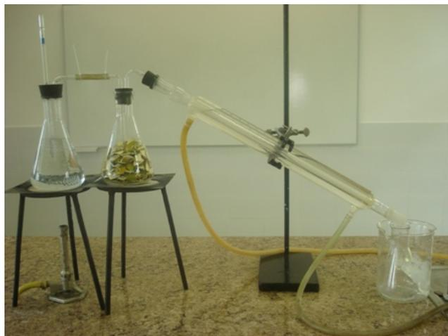
**Figura 14.** Extracción por arrastre con vapor en el laboratorio
