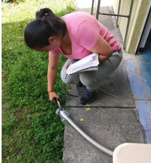
Figura 7. Mediciones de gases contaminantes en la manguera de escape
