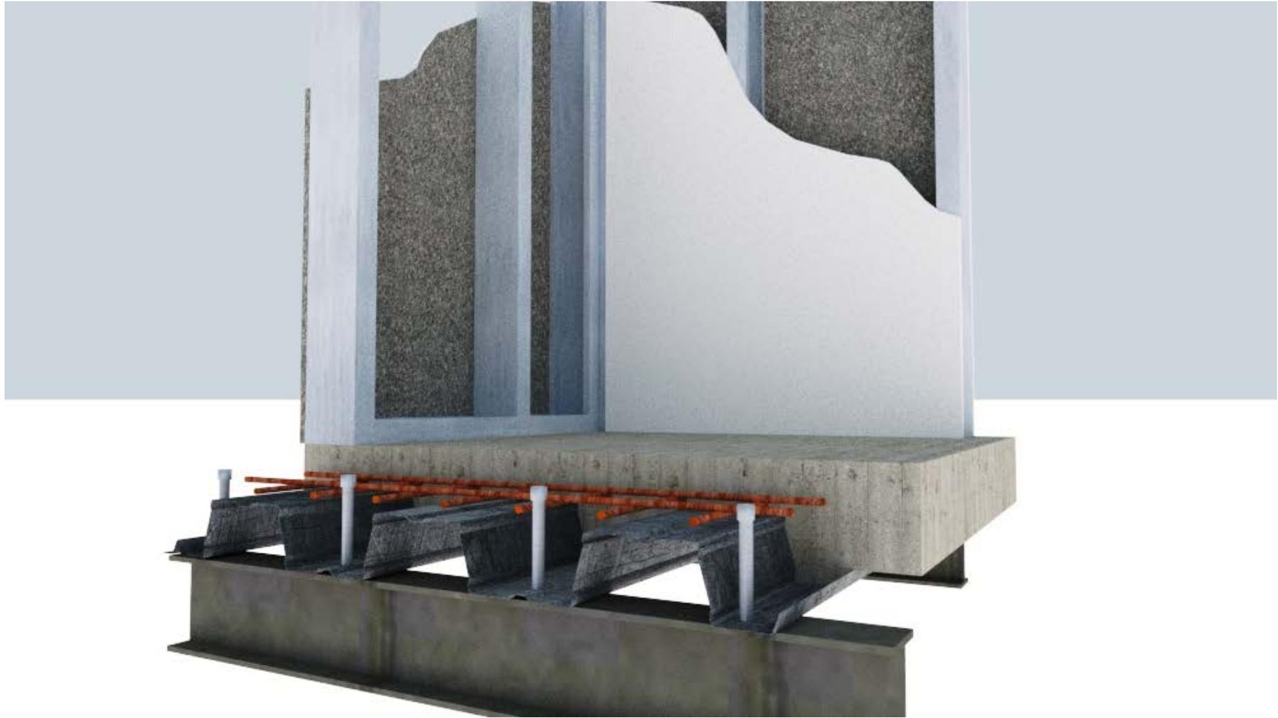
Imagen Nro. 74. *Andino, E. (2020)*. Perspectiva de detalle de construcción típico de unión estructura, losa y paredes.
