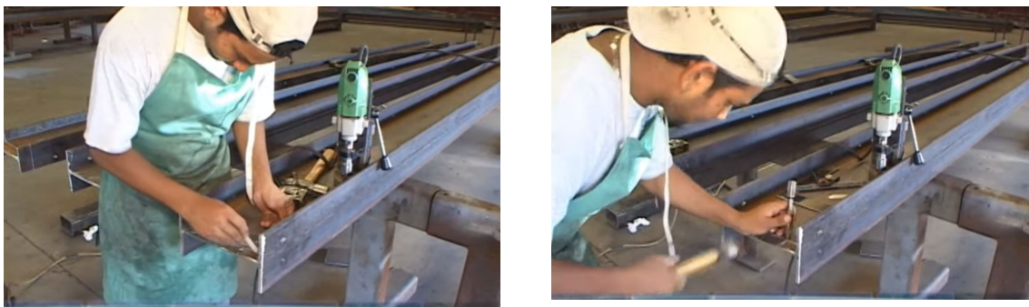
Figura 5. Proceso de perforación convencional
