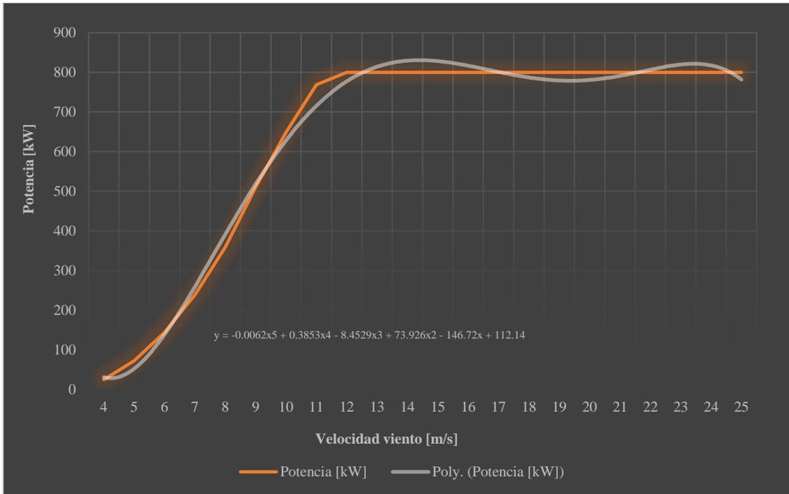
Figura 2: Curva de Potencia Aerogeneradores
