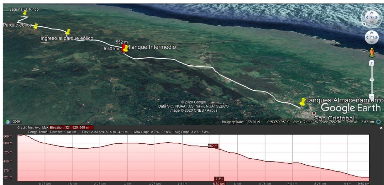
Figura 1: Trayecto de tubería laguna El Junco - San Cristóbal
