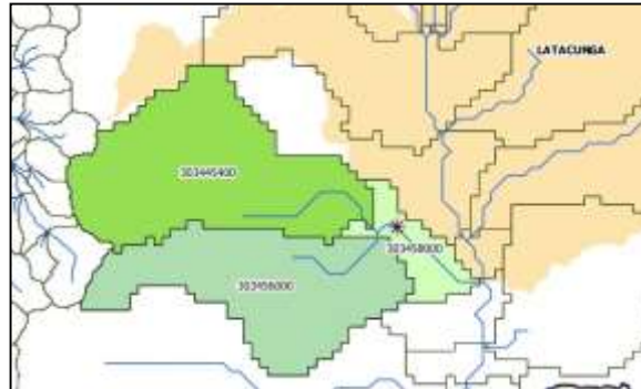
Figura 13: Microcuencas principales delimitadas para la simulación
