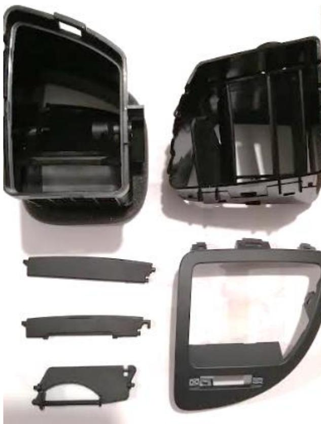
*Figura 19. Rejilla de ventilación despiezada*
