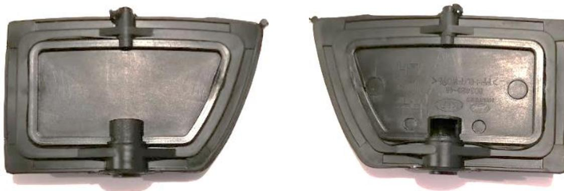
*Figura 38.* Aleta que regula el paso del aire acondicionado a la entrada de la rejilla de ventilación
