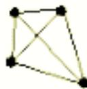
*Figura 8.* Elemento tetraédrico lineal
