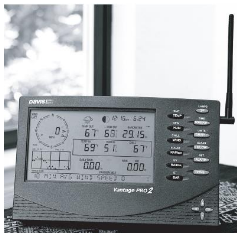
Figura 2. Estación meteorológica, Consola Vantage Pro2S
