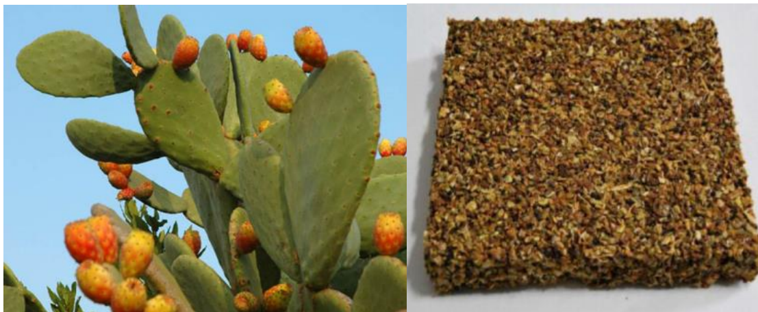
Ilustración 20 Nopal y panel aislante
