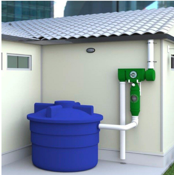
Ilustración 40 Sistema de captación de agua lluvia
