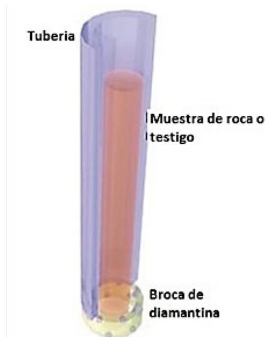
*Figura 1. Sistema de perforación a diamantina (Hubbard Drilling Services, 2019).*
