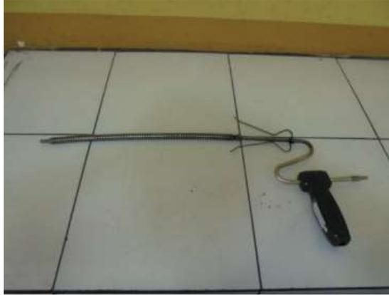
*Figura 11* Sonda de Gases de Combustión
