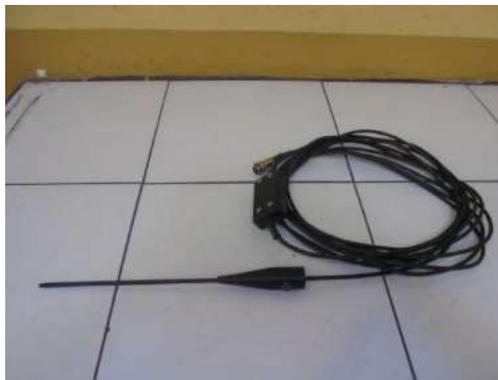
*Figura 10* Sonda de Temperatura de Aceite
