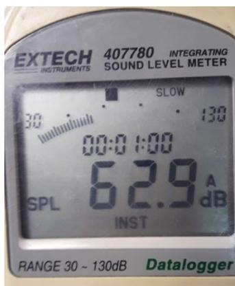
Ilustración 4: Sonómetro integrador calibrado
