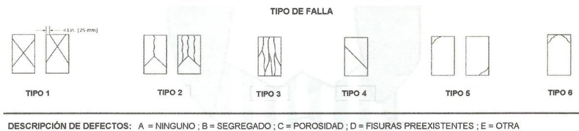
Figura 7 Tipos de fallos y defectos en ensayos de compresión. (Laboratorio EPN, 2019)
