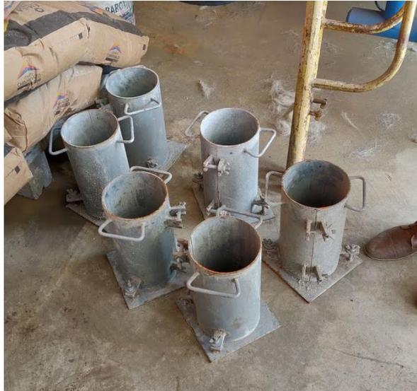
*Figura 27* Moldes cilíndricos metálicos estandarizados. (Autor)
