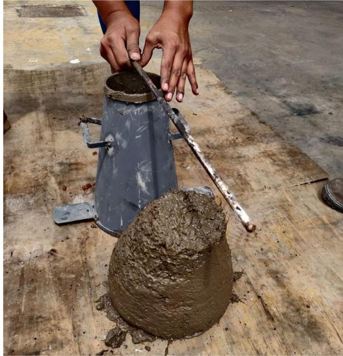
*Figura 25* Posicionamiento del cono de Abrams junto a la mezcla para realizar la medición de revenimiento. (Autor)
