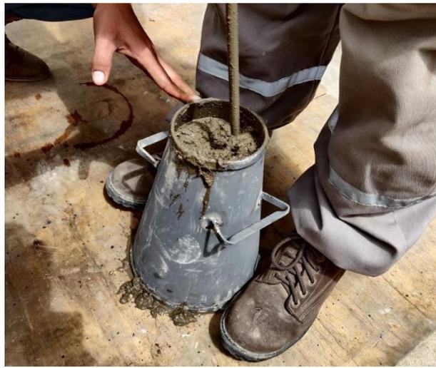
*Figura 23* Ensayo de revenimiento, inserción de la varilla para lograr liberar cualquier burbuja de aire. (Autor)
