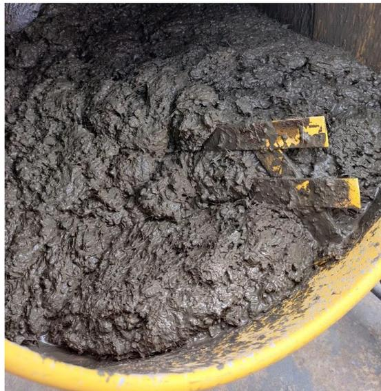
*Figura 49* Mezcla de terro-cemento con agregado de piedra pómez y el 1.7% de fibra de coco. (Autor)
