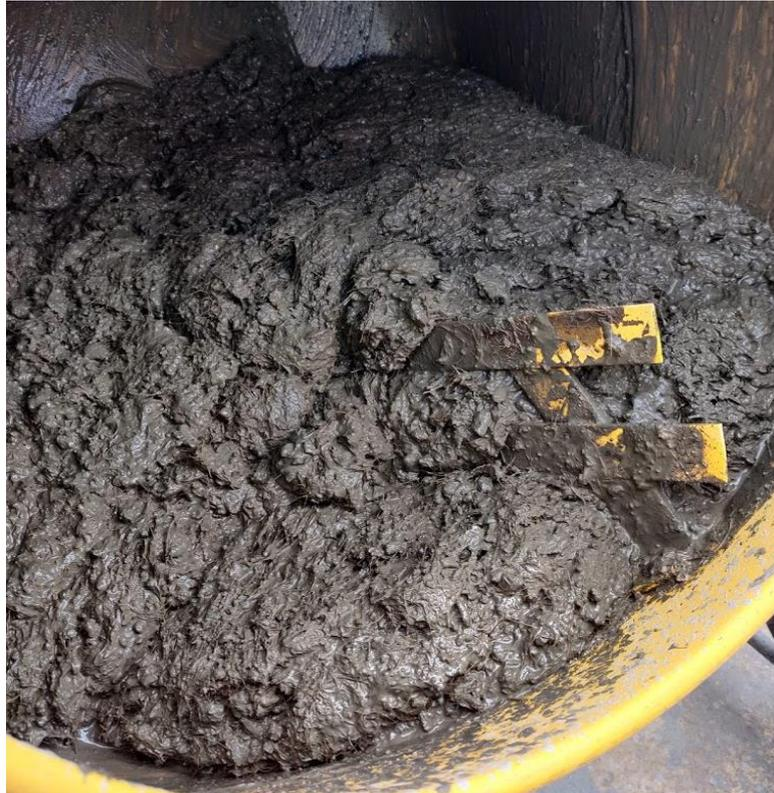
*Figura 69* Mezcla de concreto, piedra pómez y fibra de coco. (Autor)
