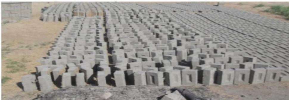
*Figura 5* Proceso de secado del ladrillo crudo. (Galoc, 2012)
