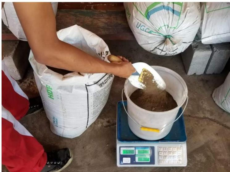
*Figura 21* Pesaje del agregado fino. (Autor)
