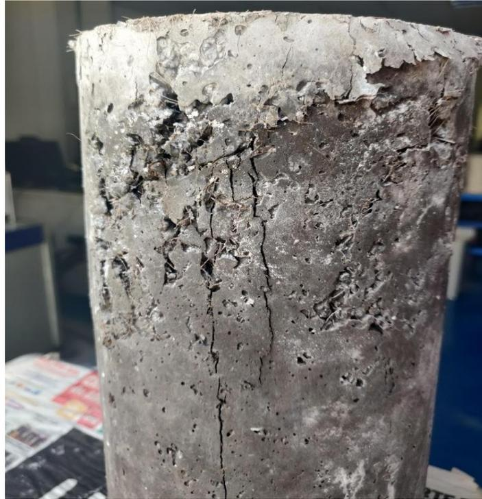
*Figura 53* Falla de tipo 3 visibles en probetas con 0.6% de fibra de coco y cemento de alta resistencia HE. (Autor)
