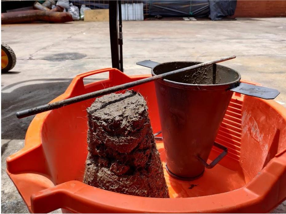
*Figura 67* Revenimiento menor al aceptado en la norma, la mezcla poseía gran cantidad de fibra de coco, lo cual demandó mayor uso de agua, dando como resultado un revenimiento casi nulo. (Autor)
