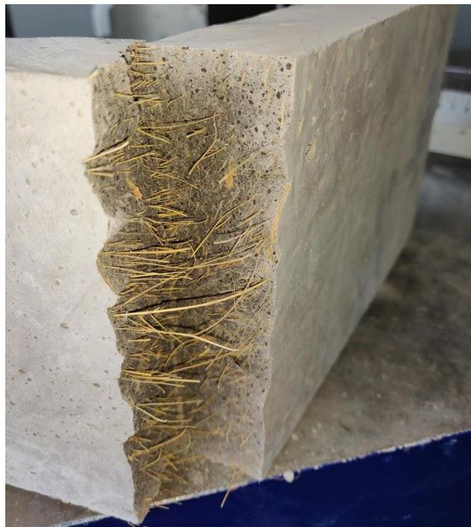
*Figura 64* Fibra de coco incorporada en la mezcla de concreto en un 5%. (Autor)
