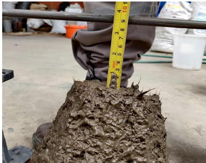
*Figura 26* Medición del ensayo de revenimiento. (Autor)
