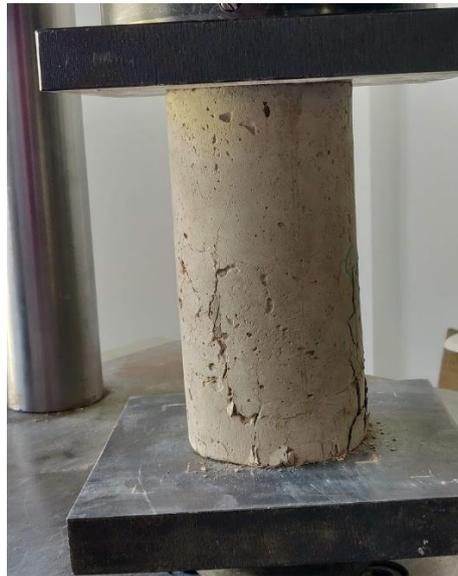
*Figura 41* Apreciación del tipo de falla 2 en probetas de concreto ensayadas a compresión. (Autor)
