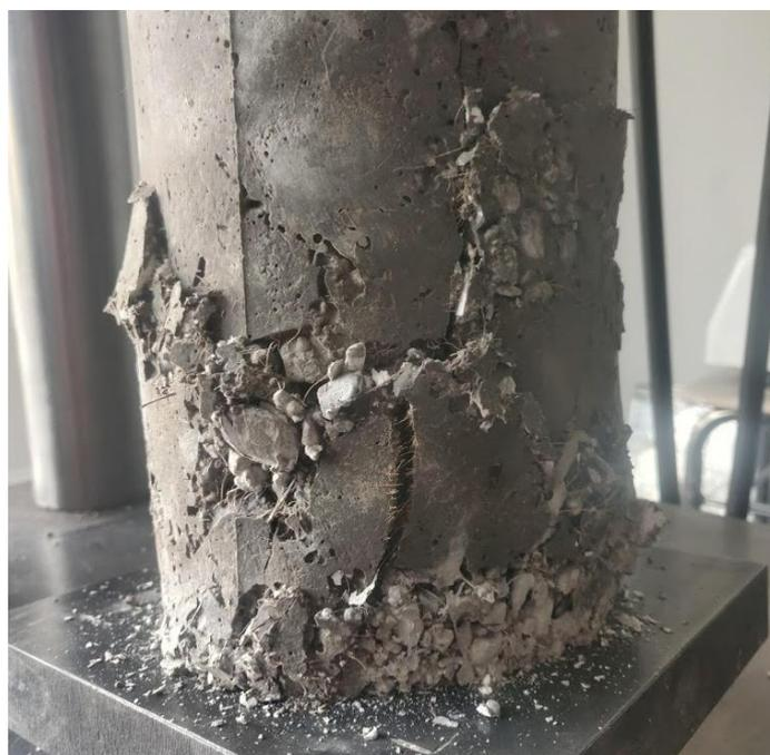
*Figura 52* Falla de tipo 3 visibles en probetas con agregado de 1.7% de fibra de coco ensayadas a compresión. (Autor)
