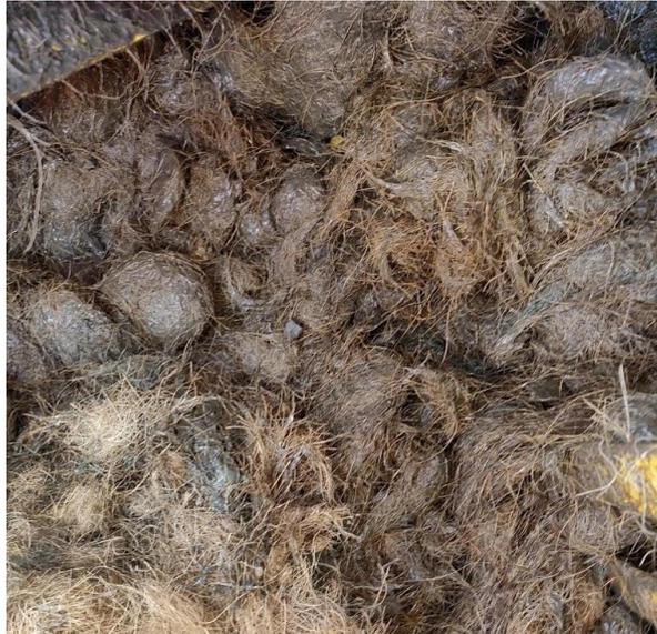
*Figura 48* Mezcla de terro-cemento con piedra pómez y el 5% de fibra de coco. (Autor)
