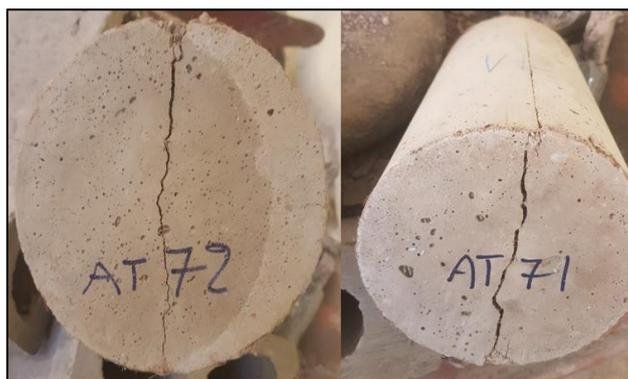
*Figura 40* Probetas de terro-cemento con adición de fibra de coco, tras realizar el ensayo, el material logra estar sujeto sin desprenderse entre sí. (Panamá 2019)
