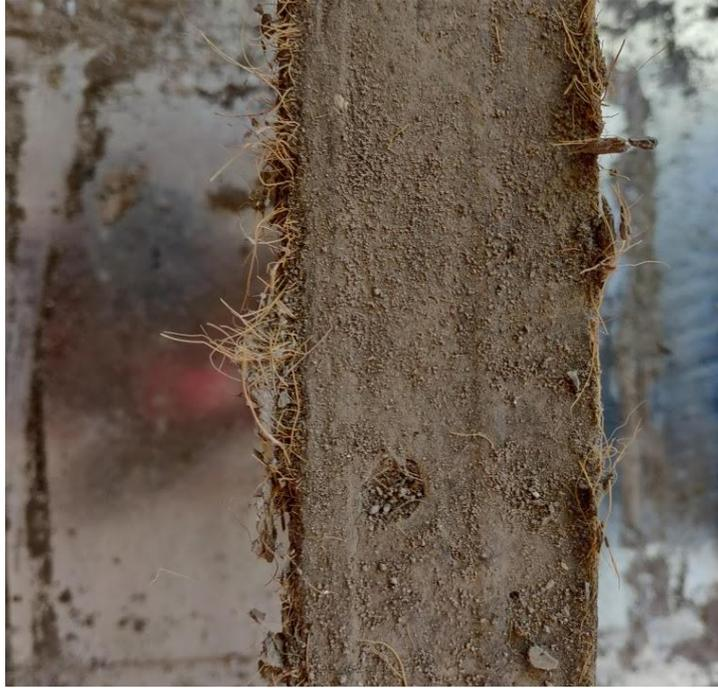
*Figura 65* Excedente de fibra de coco visible en la superficie de probetas rectangulares. (Autor)
