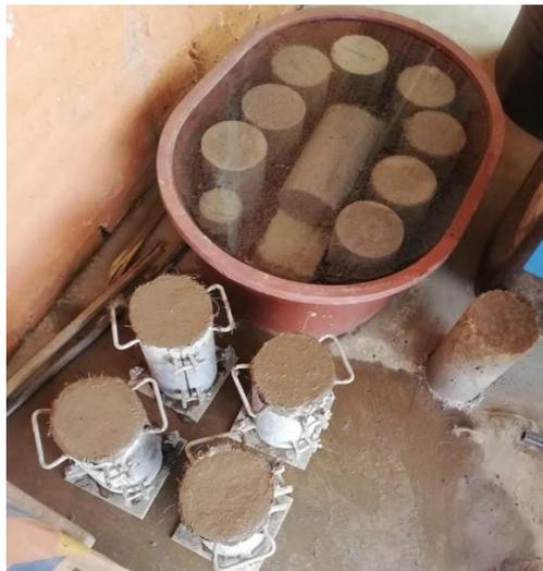
*Figura 29* Curado de las probetas. (Autor)
