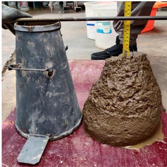
Figura 14 Toma de medida del proceso de revenimiento. (Autor)
