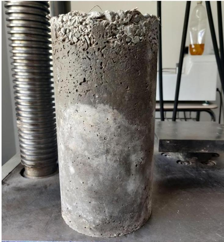
*Figura 50* Apreciación de tipos de defectos de porosidad excesiva visibles en una probeta sin ensayar, que cuenta con 1.7% de fibra de coco y piedra pómez. (Autor)
