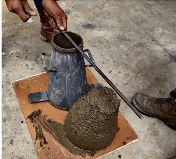
*Figura 10* Apreciación de la mezcla de concreto, luego de haber sido retirado del molde. (Autor)
