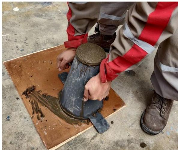
*Figura 24* Levantamiento del cono de Abrams, realizar el proceso en un tiempo de 4 a 7 segundos, levantamiento perpendicular a la base, no se debe realizar movimientos bruscos. (Autor)
