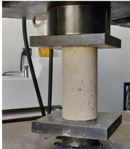
*Figura 30 Ensayo de resistencia a la compresión. (Autor)*
