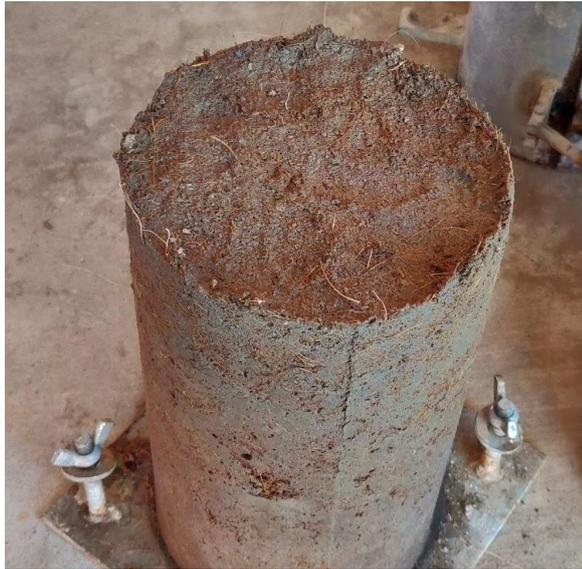
*Figura 45* Irregularidad superficial en probetas con un agregado del 10% de fibra de coco. (Autor)
