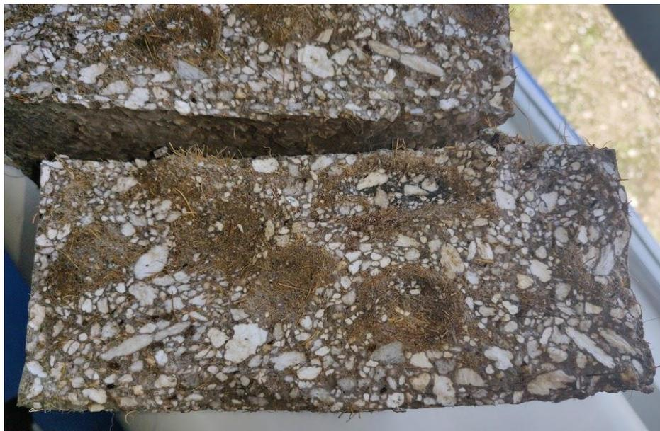
*Figura 51* Defectos encontrados en ladrillos fabricados con porcentajes de 1.7% de fibra de coco. (Autor)
