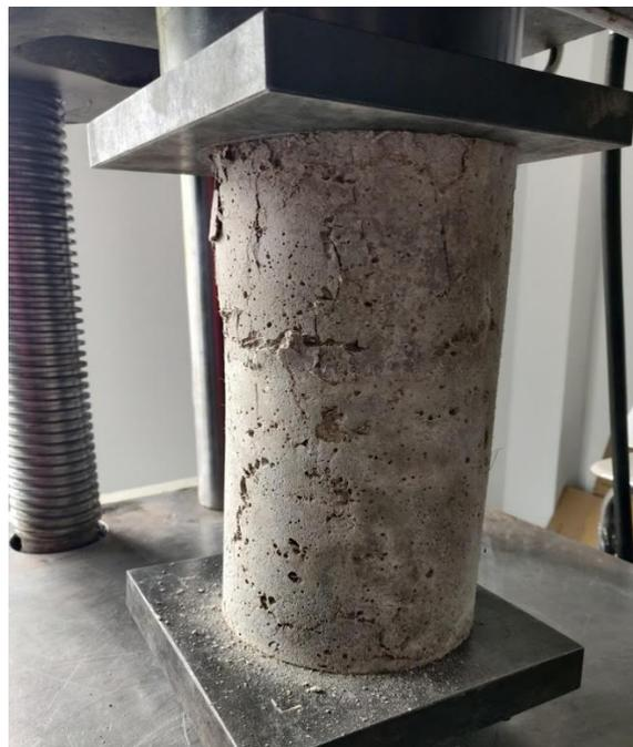
*Figura 8* Apreciación de falla "tipo 2 y 3" con defectos de porosidad durante el ensayo de resistencia a la compresión aplicado a probetas de concreto con 14 días de edad, se puede apreciar como bien formado en el extremo inferior con fisuras verticales en el extremo superior y un cono mal formado. (Autor)
