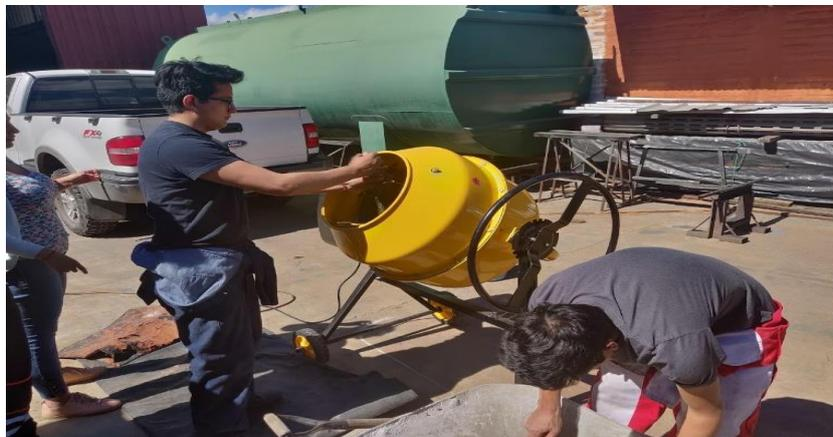
*Figura 22 Adición de materiales para el proceso de mezclado. (Autor)*
