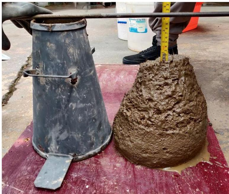
*Figura 70* Revenimiento de la mezcla vista en la figura 69, la cual se encuentra dentro de los parámetros que rigen la norma. (Autor)
