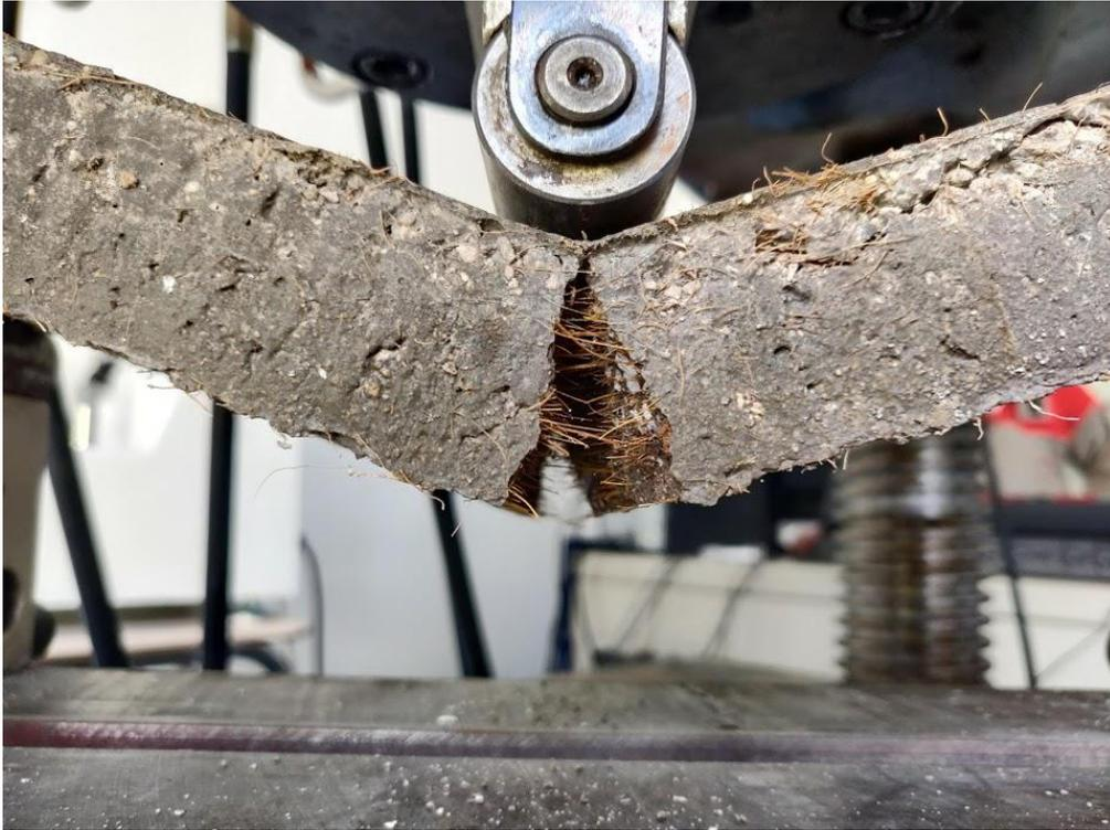
*Figura 71* La fibra de coco ayuda a sostener la probeta de concreto luego de haber sido sometida a un ensayo de flexión. (Autor)
