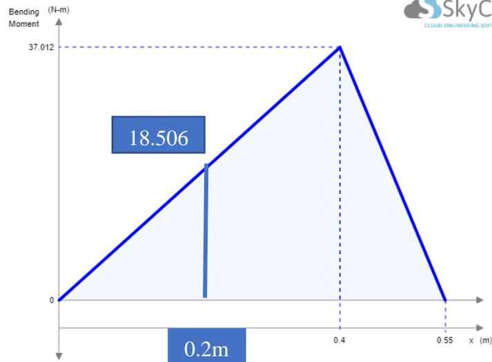
Figura 31. Diagrama Momento Flector X-Z
