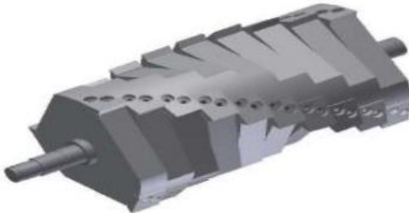
*Figura 10. Triturador de un eje con cuchillas desfasadas.*
