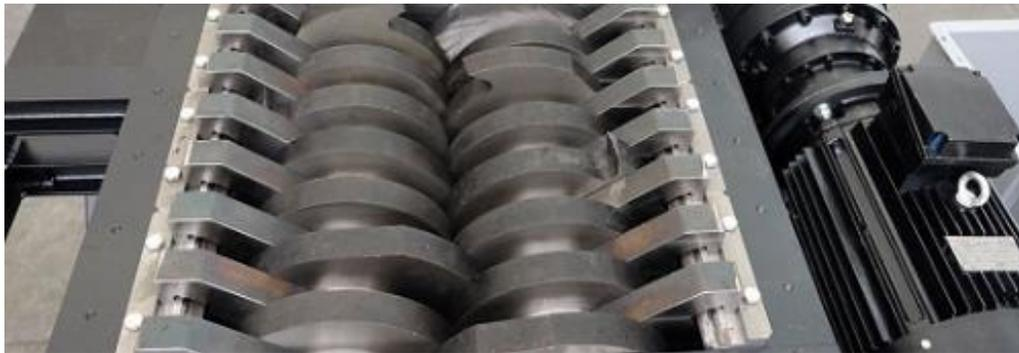
*Figura 9. Trituradora doble eje*
