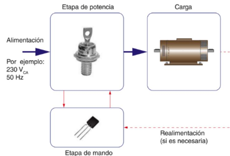
Figura 7.2. Diagrama de bloques de electrónica de potencia.
