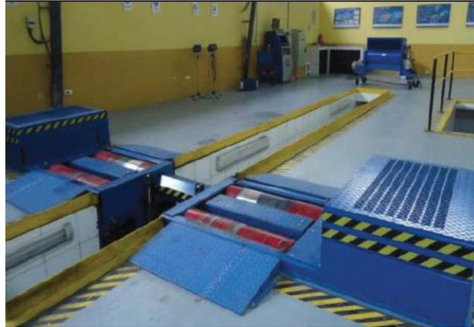
*Figura 3.* Dinamómetro de chasis LPS 3000
