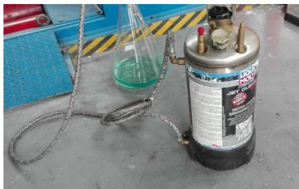
*Figura 6.* Recipiente para el control del consumo de combustible
