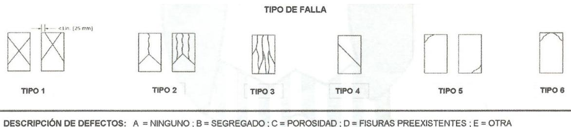
Figura 5. Tipos de fallos y defectos en ensayos de compresión.
