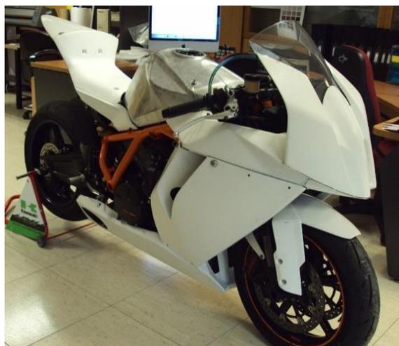
Frenos (figura 22), su función es reducir la velocidad o detener la motocicleta completamente. Por lo general, los más usados en este tipo de vehículos son frenos de disco, que cuentan con un caliper con pastillas que están sobre el disco y que, al momento de accionar la palanca de freno, la bomba hidráulica de este sistema ejerce presión sobre las pastillas que, a la vez, actúan friccionando al disco para reducir su movimiento deteniendo la motocicleta.
