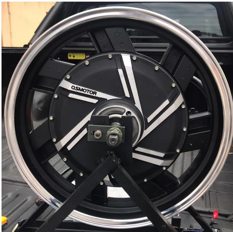
Anexo 5. Motor eléctrico de rueda posterior QSMOTOR.
