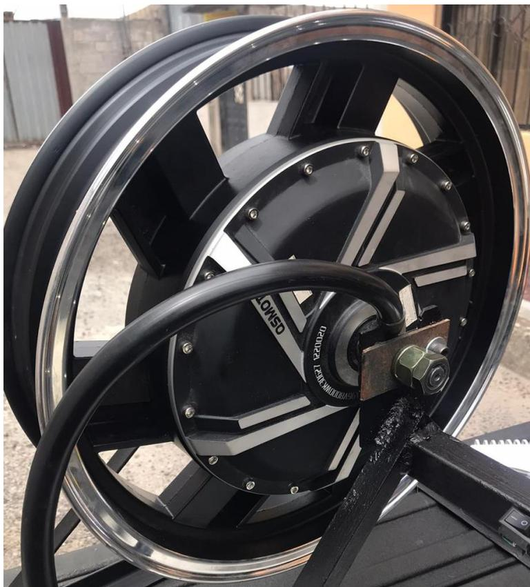
Anexo 6. Motor eléctrico de rueda posterior QSMOTOR 2.
