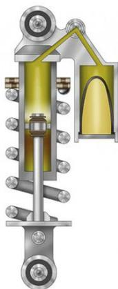
Una de las ventajas de los amortiguadores de altas prestaciones, alta calidad y, por ende, de costos más elevados, es que cuentan con un sistema de regulación (figura 36), donde se puede ajustar la precarga en el resorte e incluso se puede regular el flujo del aceite.
