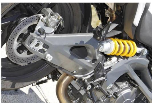
En general, la mayoría de suspensiones traseras usadas por los diferentes fabricantes de motocicletas a combustión o eléctricas –que son destinadas a ser usadas dentro de la ciudad, en caminos pavimentados y técnicamente en buen estado–, son bastante rígidas, pues no necesitan de un alto grado de amortiguación y son bastante simples para su diseño y construcción.
