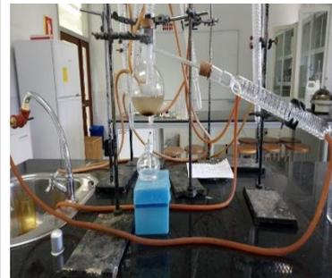
**Figura 15.** Determinación de nitrógeno total
