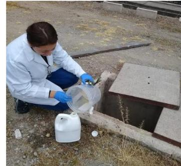
**Figura 13.** Determinación de la Demanda Bioquímica de Oxígeno (DBO<sub>5</sub>)
