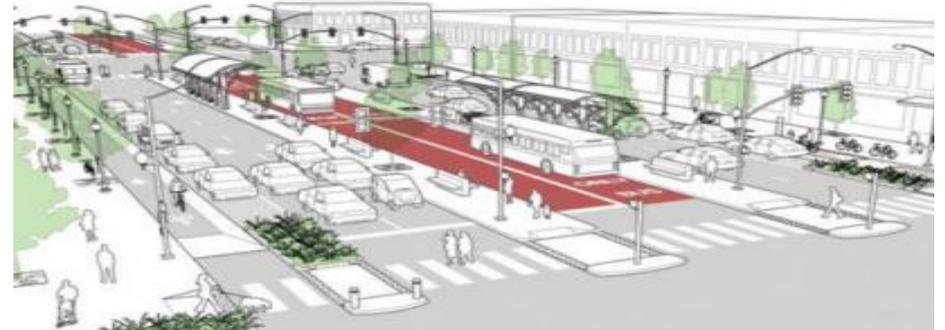
Imagen 39: Separación de los medios de Transporte. Continuidad vehicular. Fuente: Molinero. (1998).
