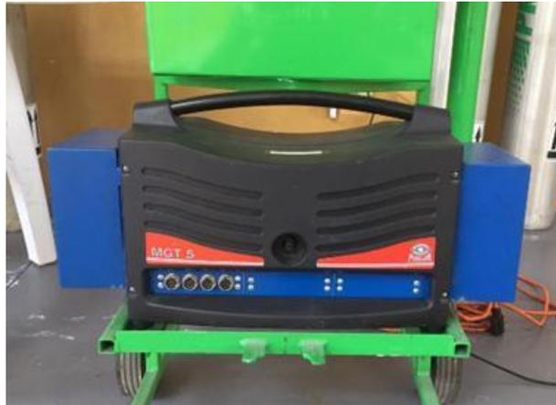
Figura 4. Equipo de medición de gases MAHA MGT 5
