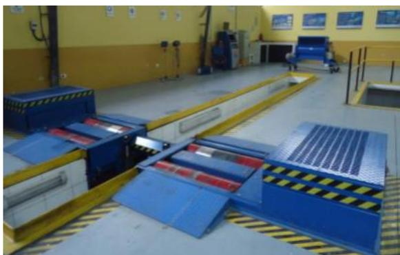
Figura 5. Dinamómetro de chasis LPS 3000
