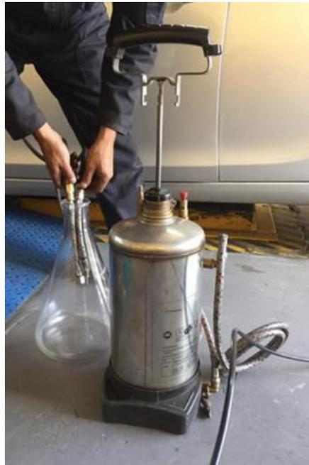
*Figura 6.* Equipo de medición de consumo de combustible
