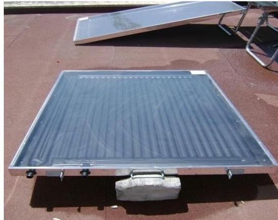
*Figura 8 Cara frontal de superficie plana absorbadora de energía solar de un colector solar térmico obtenido del conjunto de un calentador de agua*
