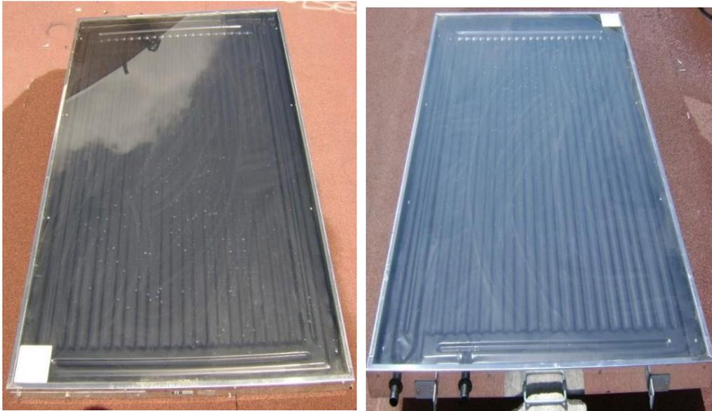
*Figura 10 Cara frontal de superficie plana absorbadora de energía solar de un colector solar térmico obtenido del conjunto de un calentador de agua, en donde se puede apreciar que la cubierta es transparente por ser de material de vidrio y que en su interior posee una placa metálica que transforma la energía solar en térmica de color negro tipo serpentín por donde fluye el aire.*
