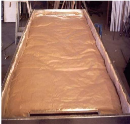
Figura 11 Dentro del interior del colector solar térmico obtenido del conjunto de un calentador de agua, se puede apreciar el aislamiento térmico, el cual recubre la parte inferior del mismo para evitar pérdidas de energía térmica al exterior, el material con el que se reviste esta base es lana de vidrio (Típo et al., 2007).
