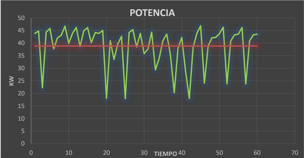
Figura 27. Curva consumo de potencia eléctrica del cuarto de los compresores.
