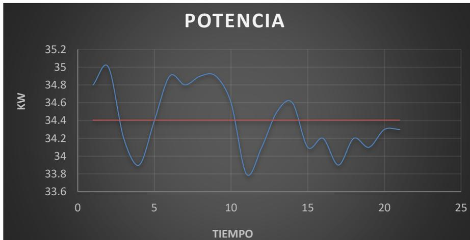
Figura 30. Curva de la potencia consumida en la granalladora.
