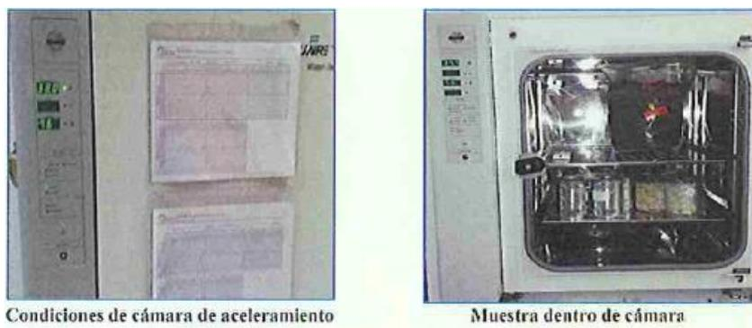
Figura 2. Cámara de estabilización acelerada
