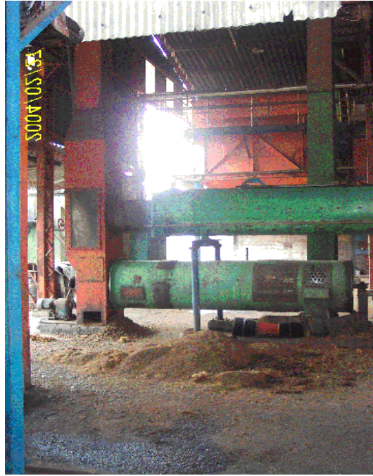
F9. Torre de separación de fibra y palmiste
