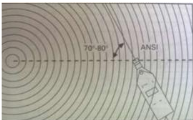
Ilustración 1 Orientación optima de los micrófonos de presión para medición de campo. Fuente: (Harris, 1995)
