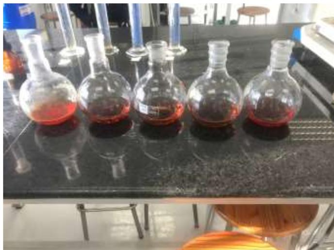
**Imagen 7.** Lixiviado tratado con reacción FENTON en diferentes dosis
