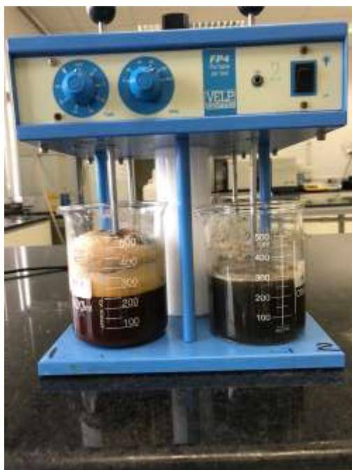
**Imagen 6.** Aplicación de reacción FENTON en el lixiviado
