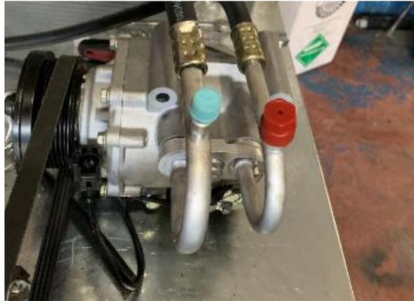
*Figura 60.* Conexión de cañerías en el compresor.
