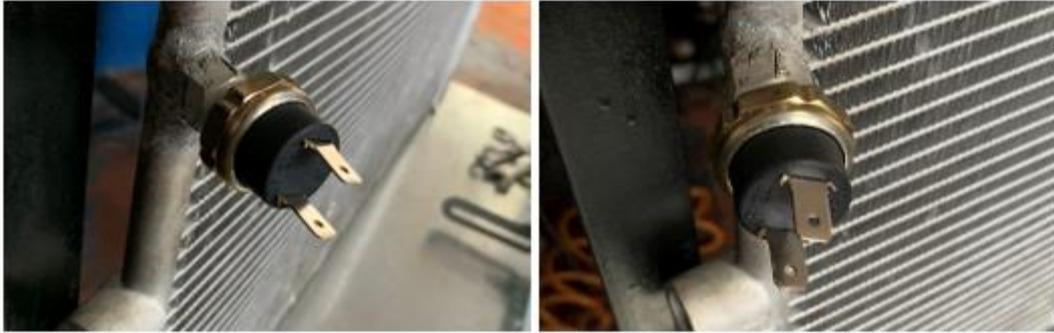
*Figura 58.* Instalación del presostato en el condensador.
