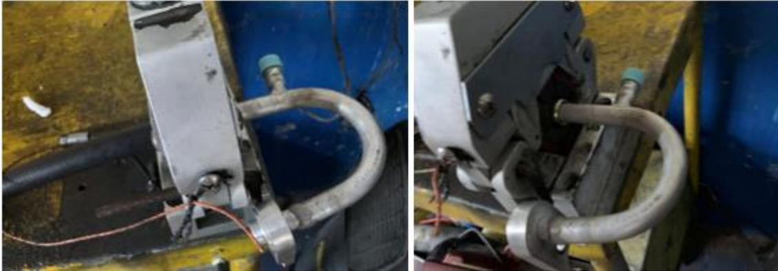
*Figura 56.* Remachado de acoples y mangueras.
