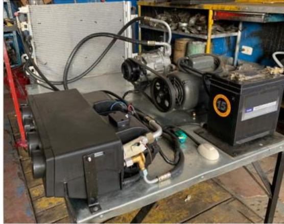
*Figura 65.* Banco de Pruebas con el Compresor R1234yf.
