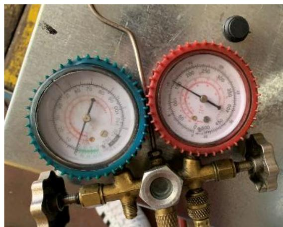
*Figura 61.* Presión 150 psi para detectar fugas.
