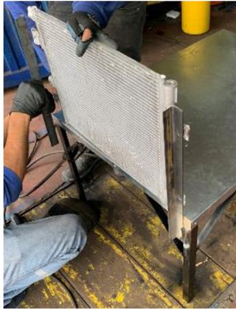
*Figura 46.* Instalación de condensador.
