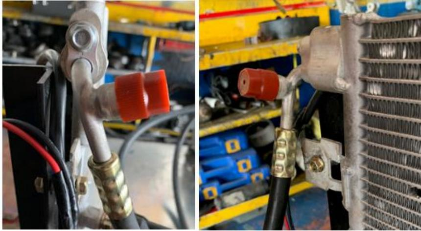
*Figura 62.* Adaptación de válvula de medición, circuito HIGH.
