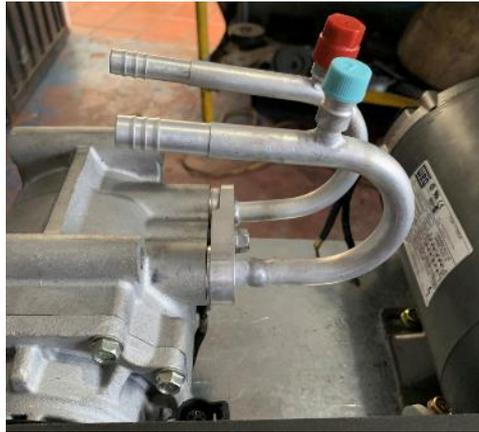
*Figura 53.* Instalación de las Válvulas LOW y HIGH, compresor R134a.
