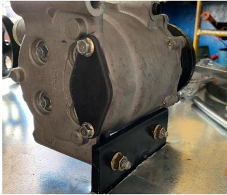
*Figura 48.* Instalación del compresor R134a.
