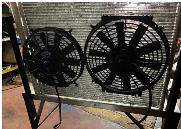
*Figura 47.* Instalación de electro-ventiladores en el condensador.
