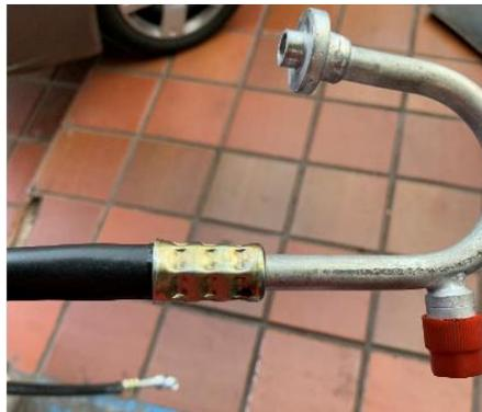
*Figura 57.* Unión de manguera y acoples por medio del remache.
