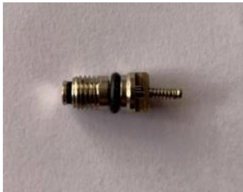
*Figura 38.* Mecanismo interno de la válvula de carga.
