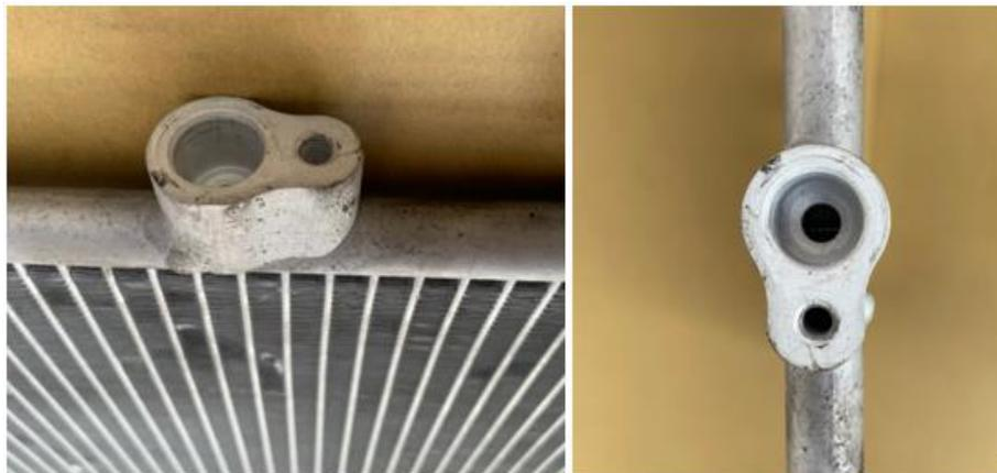
*Figura 35.* Tomas del Condensador de Aire Acondicionado.
