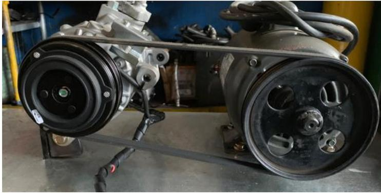
*Figura 51.* Instalación de banda de accesorios Compresor R1234yf.
