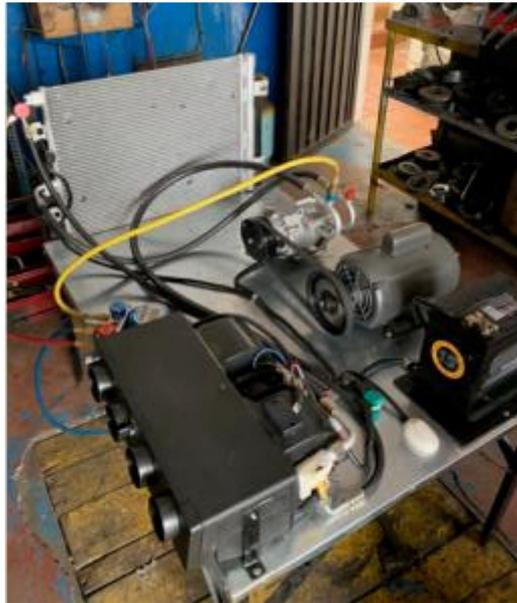
*Figura 64. Banco de Pruebas con el Compresor R134a.*
