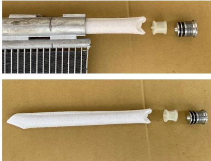
*Figura 36.* Filtro deshidratador de Aire Acondicionado.
