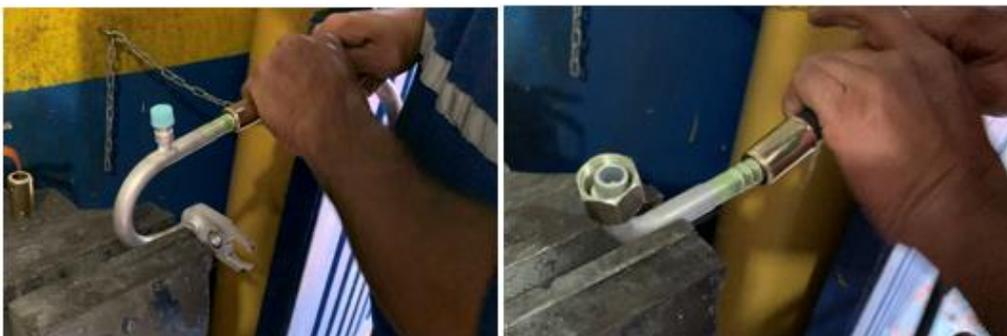
*Figura 55.* Construcción de copillas y mangueras.
