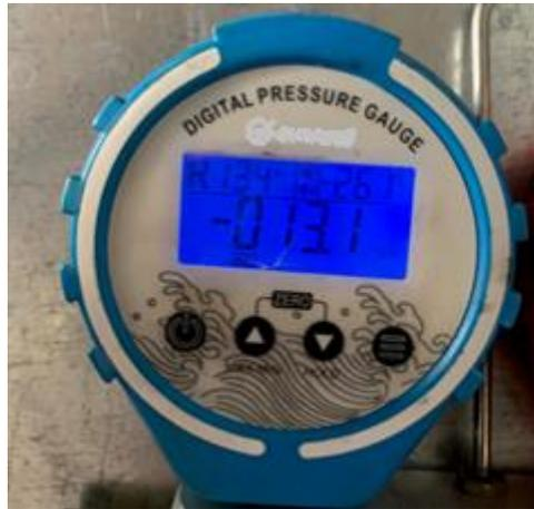
*Figura 71.* Unidades de Presión de Vacío.
