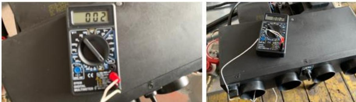
*Figura 97.* Temperatura tomada por medio de un multímetro con termocupla, 1er análisis.
