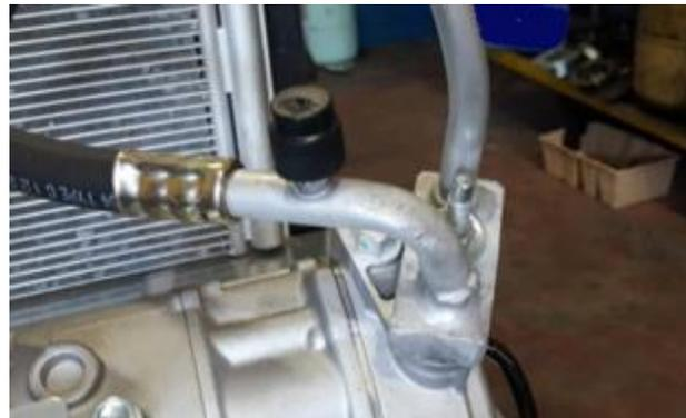
*Figura 54.* Instalación de las Válvulas LOW y HIGH, compresor R1234yf.
