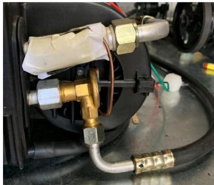
*Figura 59.* Conexión de cañerías hacia al evaporador.
