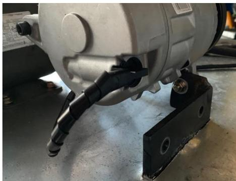
*Figura 49.* Instalación del compresor R1234yf.
