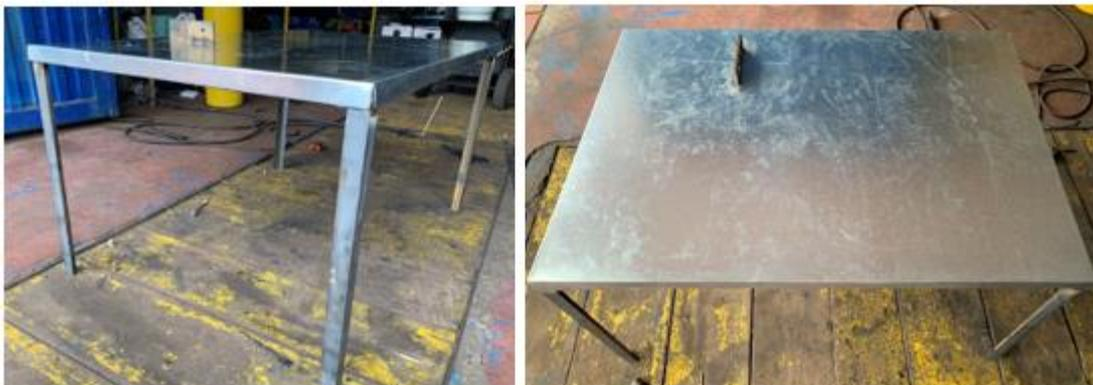
*Figura 45.* Instalación de plancha de tol a la estructura metálica.
