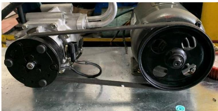
*Figura 50.* Instalación de banda de accesorios Compresor R134a.
