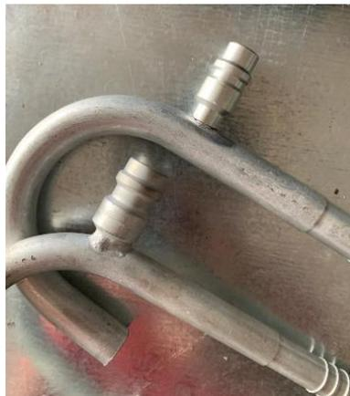
*Figura 52.* Válvulas LOW y HIGH de aluminio.
