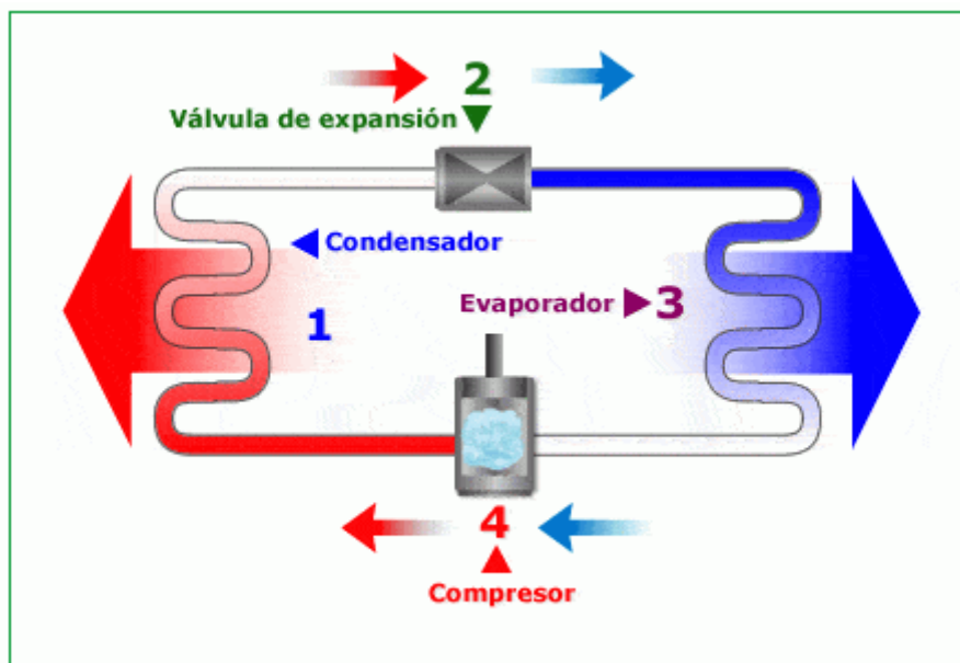
Figura 1. Ciclo de refrigeración. Fuente: (AireAcondicionado, 2015).
