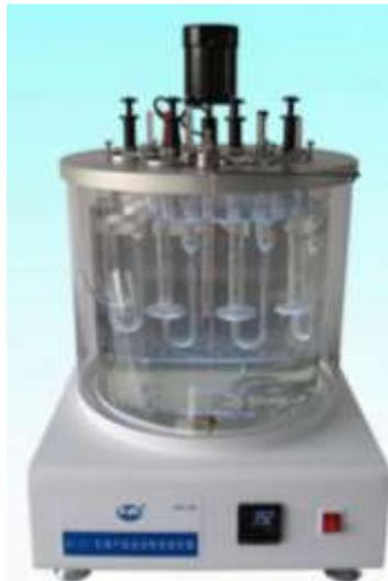
*Figura 21 Medidor de viscosidad cinemática*
