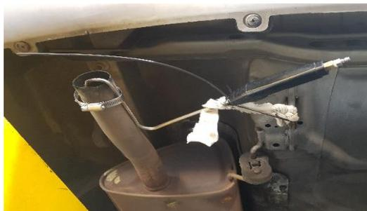
*Figura 11.* Colocación de la sonda de gases en el sistema de escape del vehículo.
