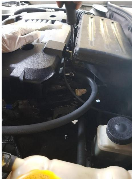
*Figura 9.* Conexión del canister al riel de inyectores.
