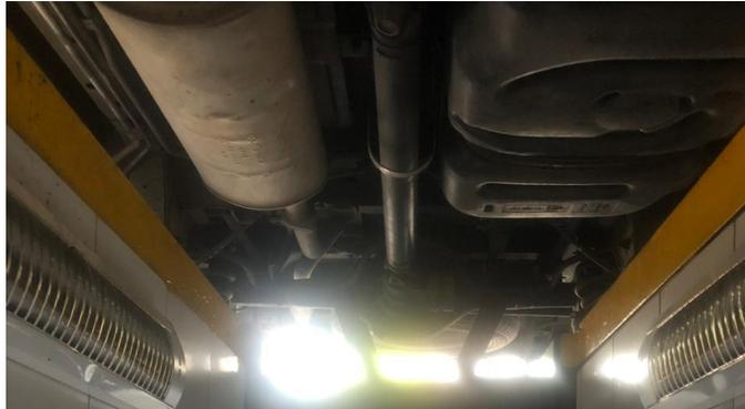
*Figura 6.* Inspección visual del sistema de escape
