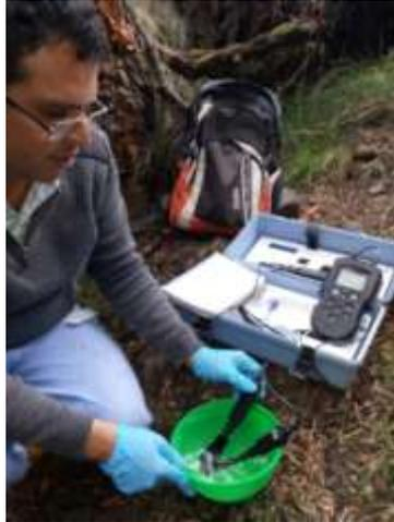
**Figura 3.** Medición de parámetros pH, conductividad eléctrica, oxígeno disuelto y temperatura con multiparámetro HACH HQ40d.
