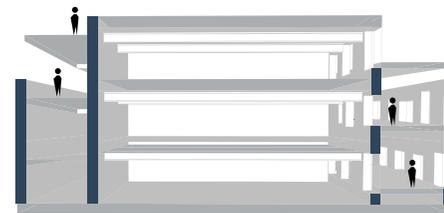
En corte se puede apreciar que los muros prefabricados definen los espacios así también como sostienen las vigas que soportan las luces interiores
