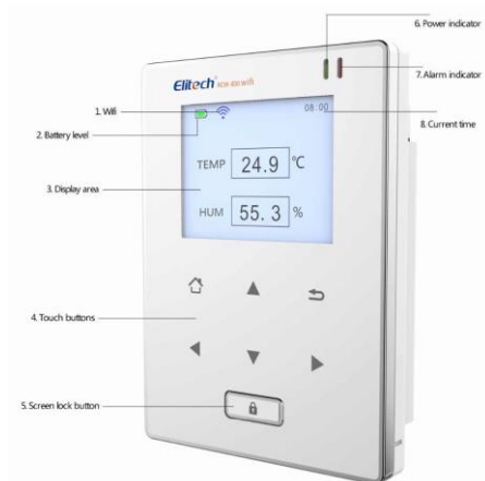
Figura 10. Termohigrómetro marca ELITECH, modelo RCW-800 wifi (EPN, 2015).
