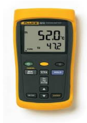
Figura 9. Termómetro digital marca: FLUKE, modelo: 521l (EPN, 2015).
