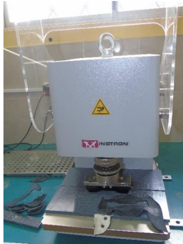
Figura 4. Troqueladora de probetas, marca INSTRON (EPN, 2015).
