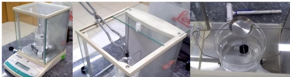
Figura 11. Ensayo de densidad en geomembranas (EPN, 2015).
