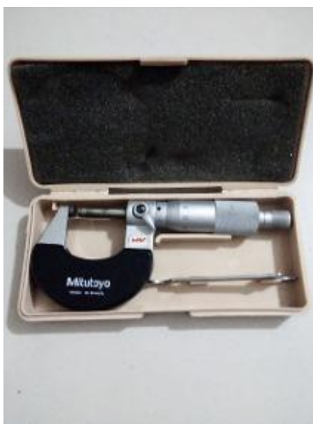
Figura 7. Micrómetro marca: Mitutoyo. Modelo: M110-25 (EPN, 2015).
