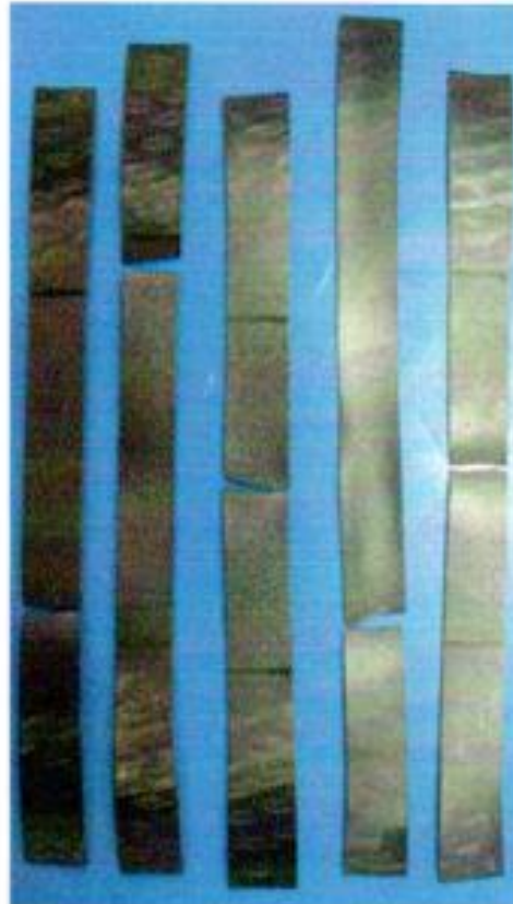
Figura 8. Condiciones finales de las probetas del grupo "PVC 1000 \mu\text{m} " después de los ensayos de resistencia a tracción ASTM D882-18
