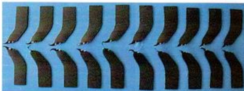
Figura 20. Condiciones finales de las probetas del grupo “HDPE 1500 \mu\text{m} ” después de los ensayos de resistencia a tracción ASTM D882-18 Fuente:(EPN,2019).
