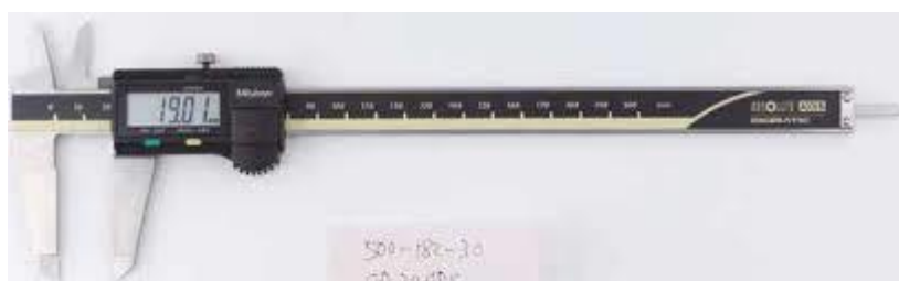
Figura 6. Calibrador de Breiner marca: Mitutoyo, modelo: Absolute Digimatic. (EPN, 2015).
