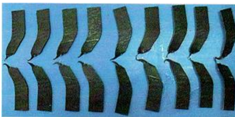
Figura 19. Condiciones finales de las probetas del grupo “HDPE 1500 \mu\text{m} ” después de los ensayos de resistencia al rasgado ASTM D1004-13 Fuente: (EPN, 2019).
