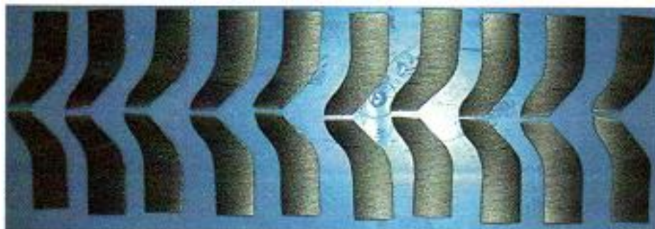
Figura 23. Condiciones finales de las probetas del grupo “PVC 1500 \mu\text{m} ” después de los ensayos de resistencia al rasgado ASTM D1004-13 . Fuente: (EPN,2019).
