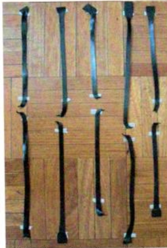
Figura 6. Condiciones finales de las probetas del grupo "HDPE 1000 \mu\text{m} " después de los ensayos de resistencia a tracción ASTM D882-18.
