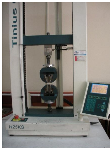
Figura 5. Máquina universal de ensayos, marca Tinius Olsen, modelo:H25KS (EPN, 2015).
