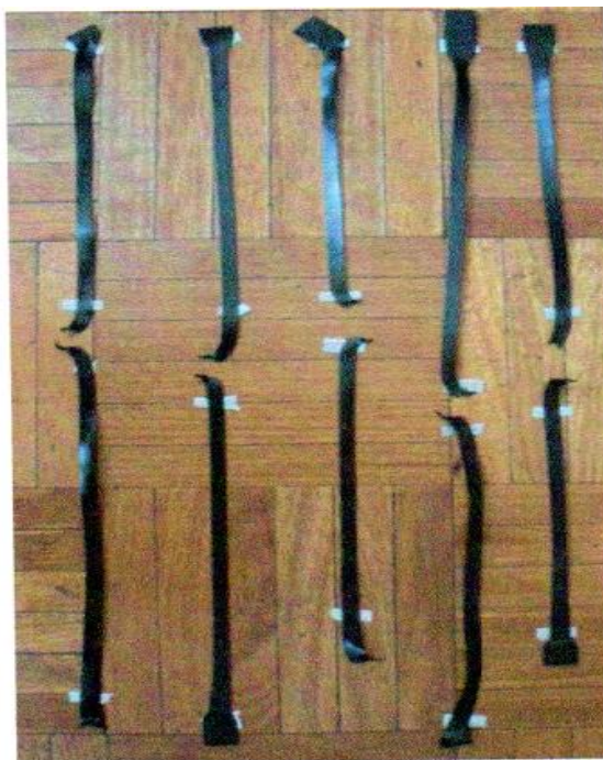
Figura 22. Condiciones finales de las probetas del grupo “HDPE 1000 \mu\text{m} ” después de los ensayos de resistencia a tracción ASTM D882-18. Fuente:(EPN,2019).
