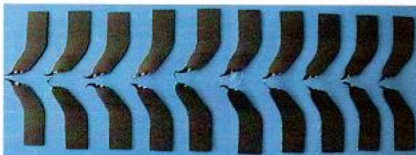
Figura 21. Condiciones finales de las probetas del grupo “HDPE 1000 \mu\text{m} ” después de los ensayos de resistencia al rasgado ASTM D1004-13, Fuente:(EPN,2019).
