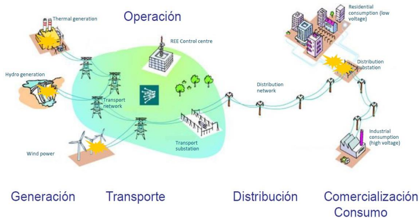
Figura # 1. Generación-Transmisión-Distribución y Consumo de Electricidad
