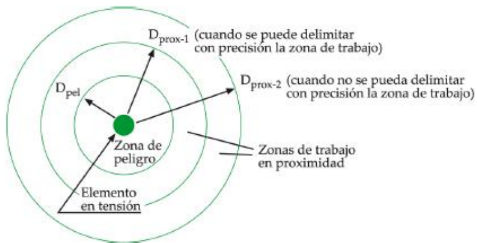
Figura # 19. Zona de aproximación trabajos en tensión sin barreras
