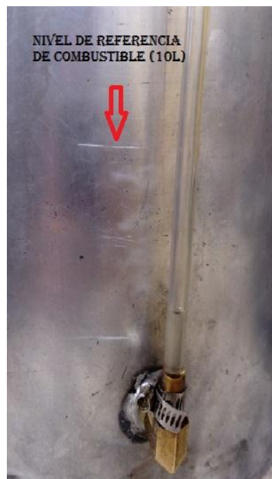
Figura 17. Nivel referencial de combustible del tanque auxiliar.
