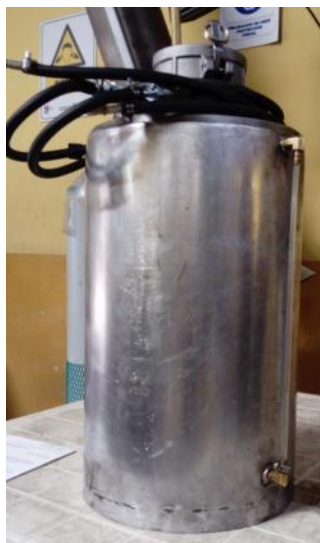
Figura 10. Tanque auxiliar de combustible.
