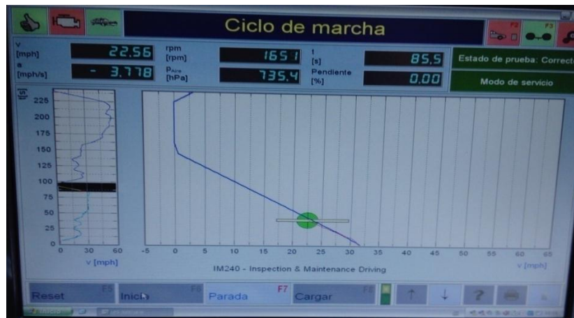
Figura 16. Ciclo de marcha IM240 en el banco de pruebas.
