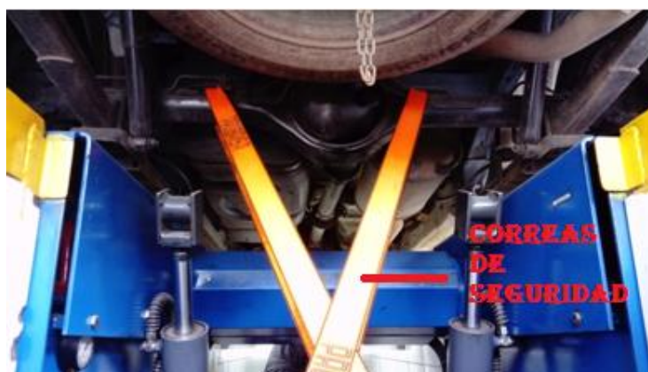
Figura 15. Implementación de correas de seguridad.
