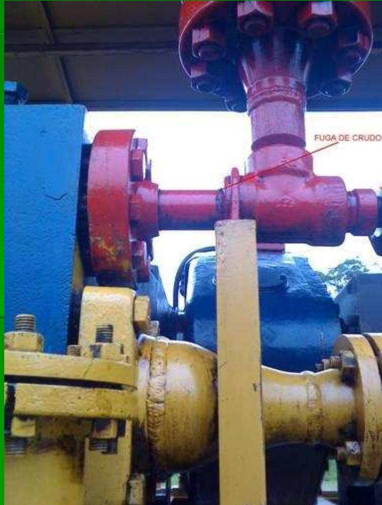
Contaminación por una fuga de crudo entre la entrada del fluid end y el Hydril, donde se regó unos 5 galones aproximadamente el cual contamina tanto el piso de la locación como al equipo quedando en gran parte el crudo dentro del cubeto colocado en la MTU.
