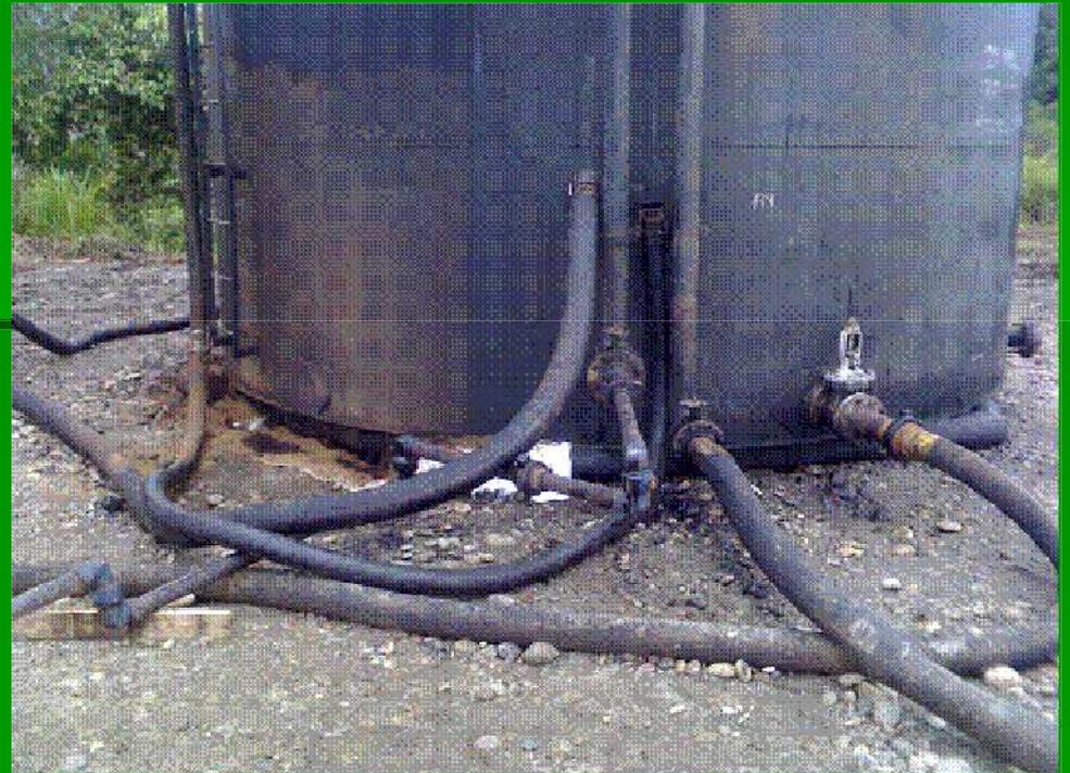
Aproximadamente a las 2:00 por el descuido y falta de control de los técnicos asignados, al no estar pendientes del nivel del tanque de almacenamiento este se llena completamente y empieza a regarse piso por el orificio de aforo en una cantidad no establecida
