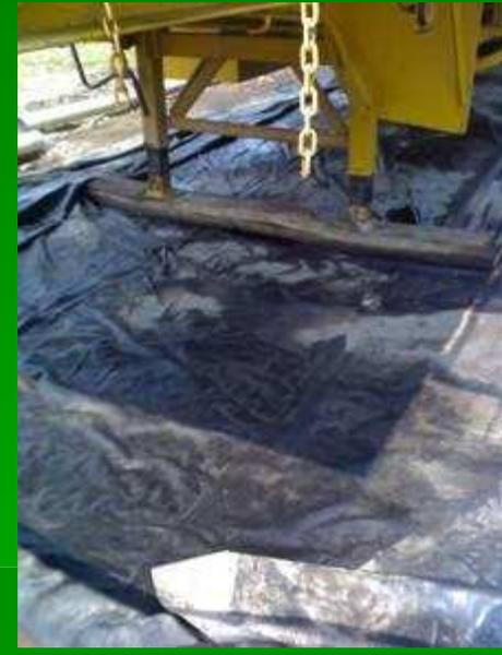
El accidente habría sido ocasionado al soltarse la manguera de nivel del tanque de combustible y que por gravedad se derramo aproximadamente 50 galones de diesel, entrampándose en el cubeto de la unidad pero pese a esto se filtro por los costados contaminando el suelo en su contorno
