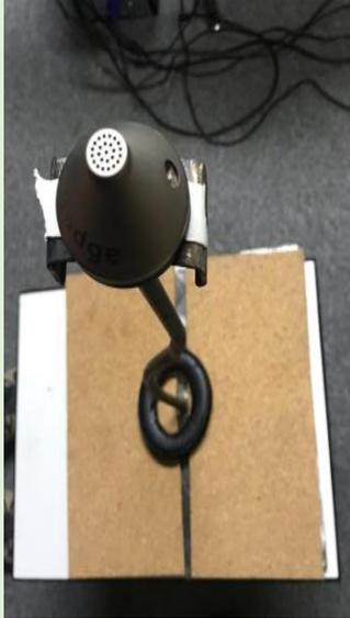
**Gráfico 18: Orificios de 6 mm, un orificio tapado.**
