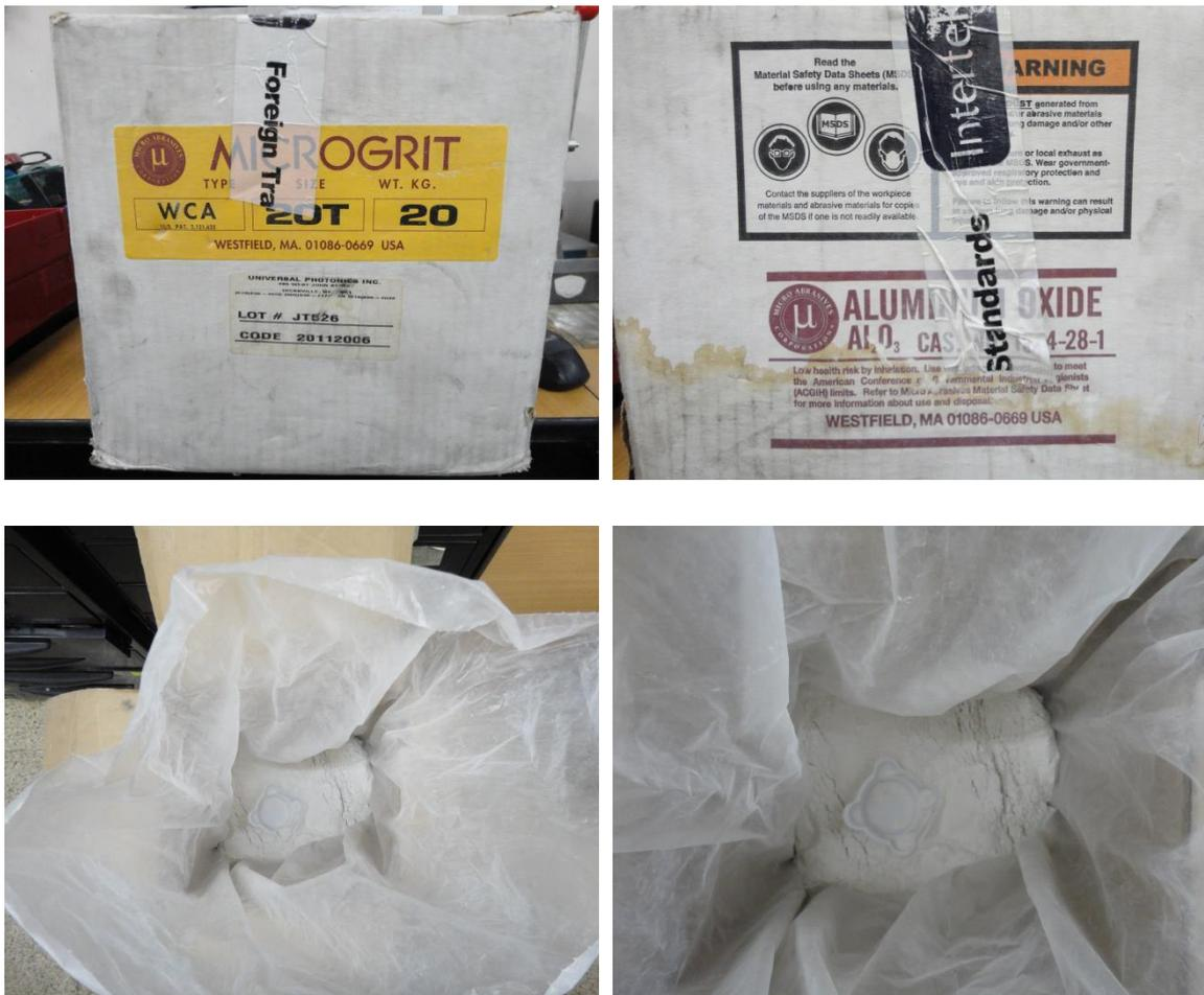
**Figura 10.** Oxido de aluminio, se usa en el desbaste de lentes ópticos
