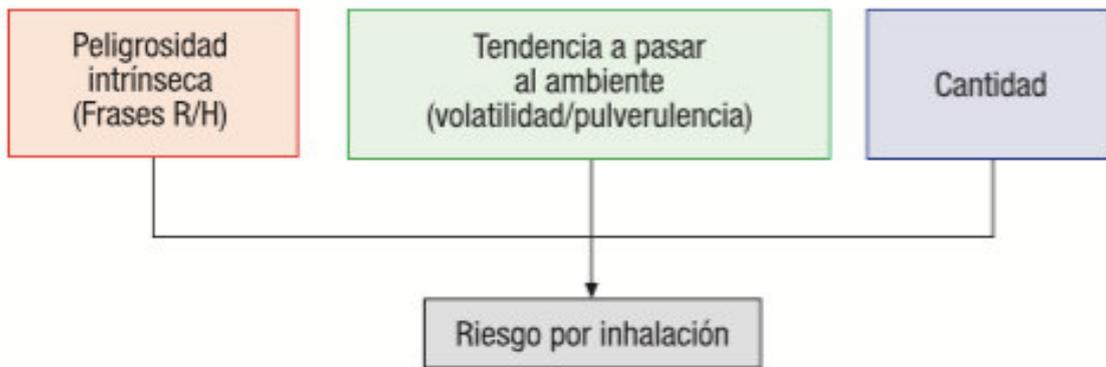
**Figura 4.** Esquema para la evaluación del riesgo por inhalación
