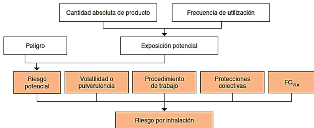
**Figura 3.** Esquema para la evaluación simplificada del riesgo por inhalación
