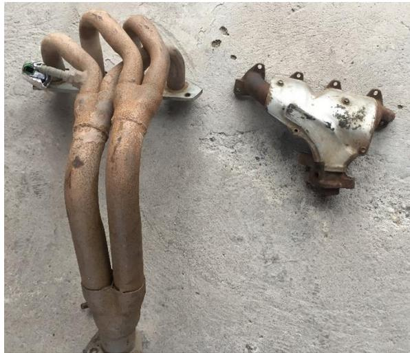
Figura 6. Diferencia entre el *header Muffler* (tubos individuales) y el múltiple de escape original (equipamiento de serie).
