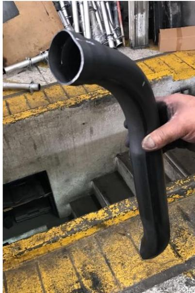
*Figura 100.* Tubo de 1 ½ Pulg. doblado en la sección del colector
