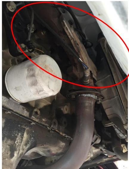
*Figura 90.* Múltiple de escape original motor G13B instalado
