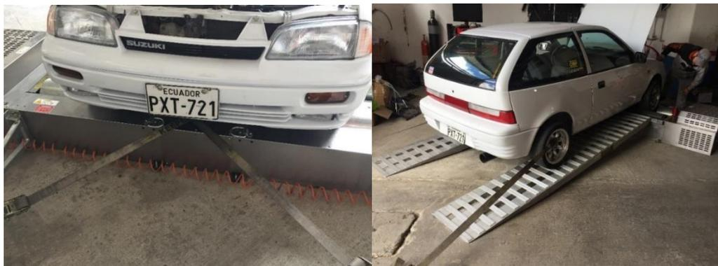
*Figura 18.* Anclaje del vehículo mediante el uso de fajas travesaño frontal y ruedas posteriores
