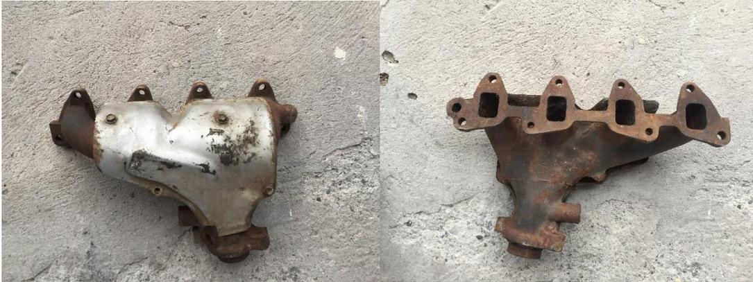
Figura 1. Múltiple de escape de serie motor G13B Chevrolet Forsa II.
