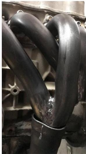
*Figura 107.* “Y” de unión del *header Muffler* hacia el tubo principal
