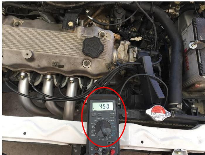
Figura 30. Tacómetro digital conectado al cable de la bujía (450 x10 RPM)
