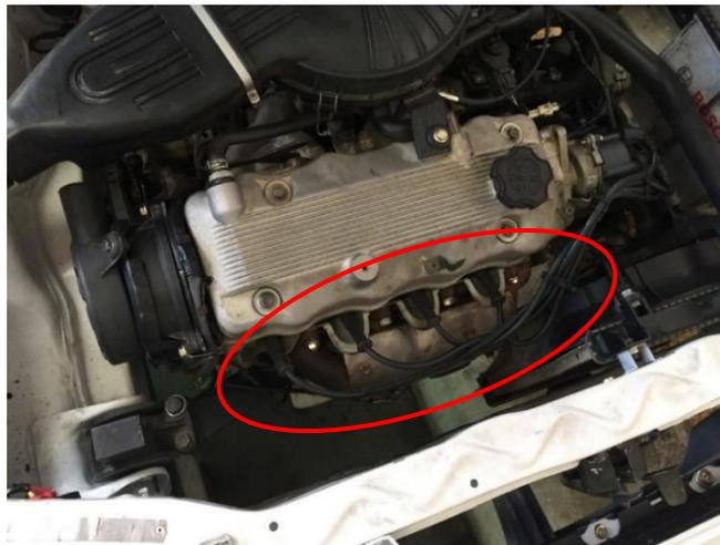
Figura 88. Motor G13B con el múltiple original de escape (equipamiento de serie)
