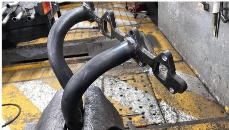
*Figura 101.* Placa de sujeción y headers 1-3 soldados
