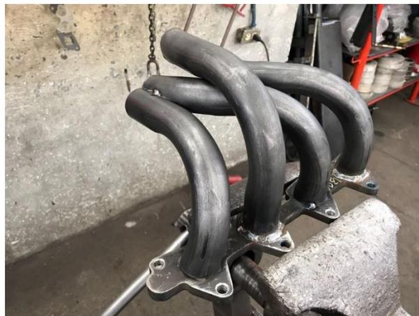
*Figura 105. Colectores del header Muffler soldados a la palca de sujeción*
