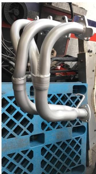
*Figura 110. Proceso de secado del header Muffler*
