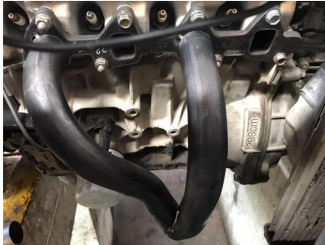
*Figura 103. Header Muffler en verificación de medidas montado en el cabezote*
