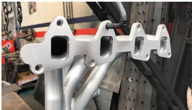
*Figura 109. Proceso de pintura del header Muffler*
