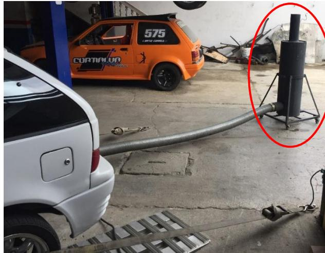
Figura 19. Tubería de desfogue y atenuador de ruidos de los gases de escape
