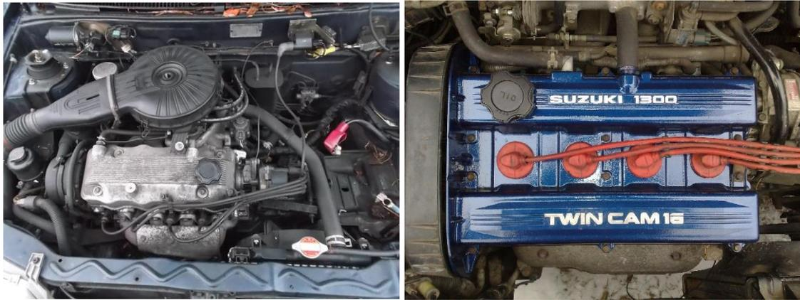
Figura 4. Motor G13B 8 y 16 válvulas
