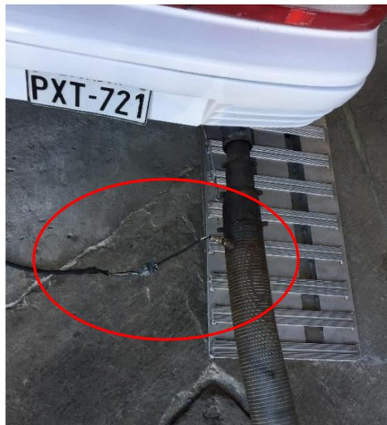
Figura 20. Sensor de oxígeno conectado a la cañería de desfogue de la salida del escape
