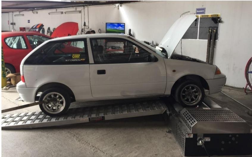
*Figura 17.* Vehículo Chevrolet Forsa II sobre el banco dinamométrico
