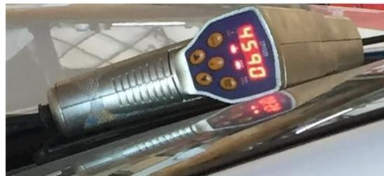
Figura 25. Lámpara estroboscópica contando las RPM.
