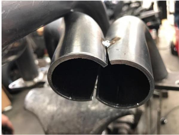
*Figura 106.* Acople del *header Muffler* hacia la unión en forma de “Y”
