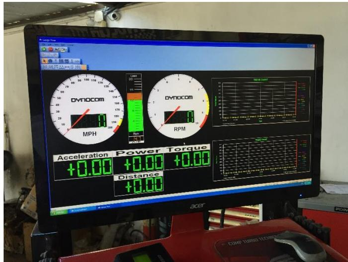
Figura 93. Ventana 1 del software que indica el régimen de aceleración y RPM
