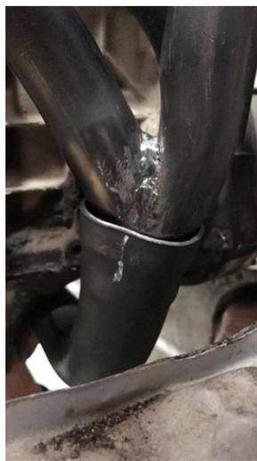
*Figura 108.* Soldadura de la “y” de unión del *header Muffler*
