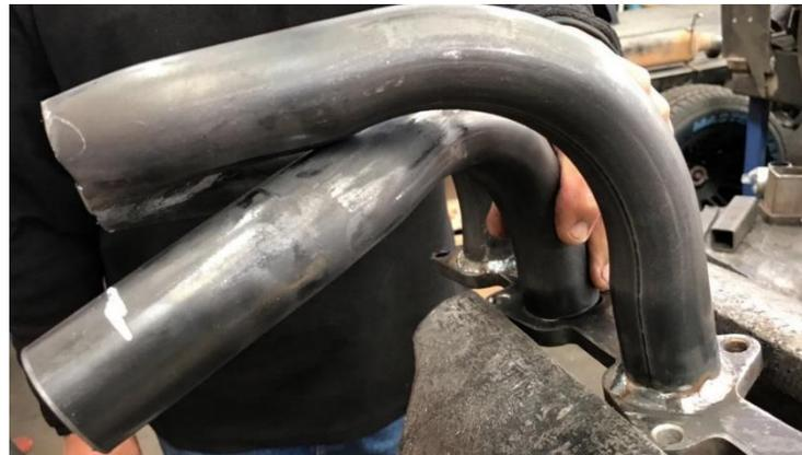
*Figura 104. Acople del header 1-3 y 4-2 a la palca de sujeción*
