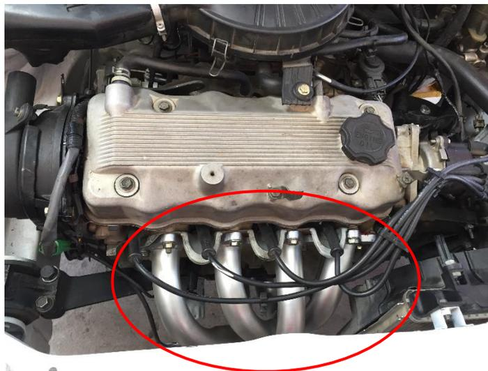
Figura 114. Motor G13B con el *header Muffler* diseñado, construido e instalado
