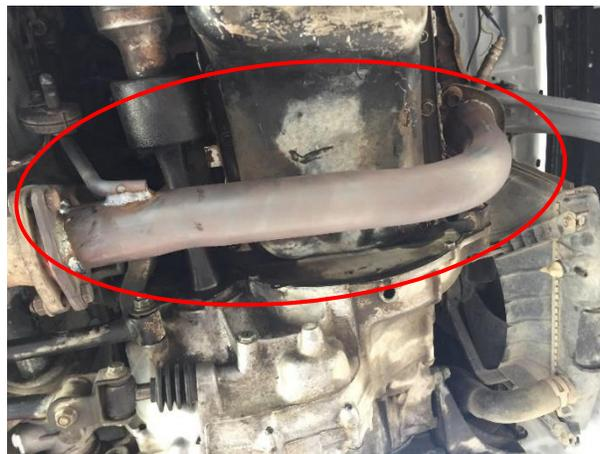
*Figura 91.* Tubo y unión del múltiple original
