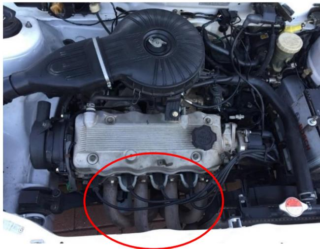
Figura 89. Motor G13B con *header Muffler* artesanal
